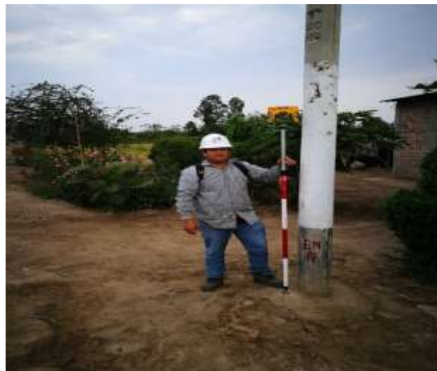
Figura 10. En la vista fotográfica se observa al personal realizando el levantamiento topográfico con el equipo utilizado (estación total) se ha identificado los BM-17 en estructuras fijas, en el sector Pósope Bajo del distrito de Pátapo.
