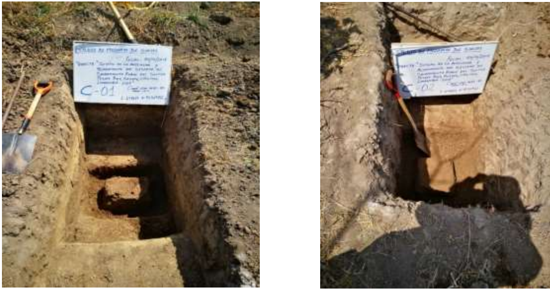
Figura 12. En la vista fotográfica se observa a la Calicata N° 01 y 02, la cual nos permiten determinar la textura de terreno del sector Pósope Bajo del distrito de Pátapo.
