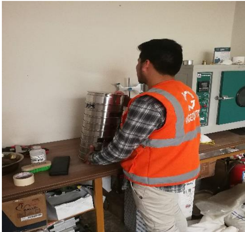
Figura 15. Realizando la clasificación de suelos según los tamices.
