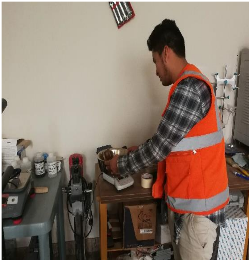
Figura 14. Peso de la muestra después de haber salido del horno
