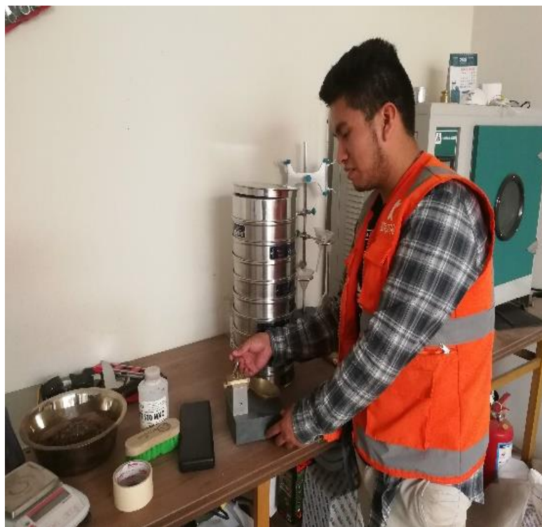
Figura 16. Realizando el ensayo de copa casa Grande
