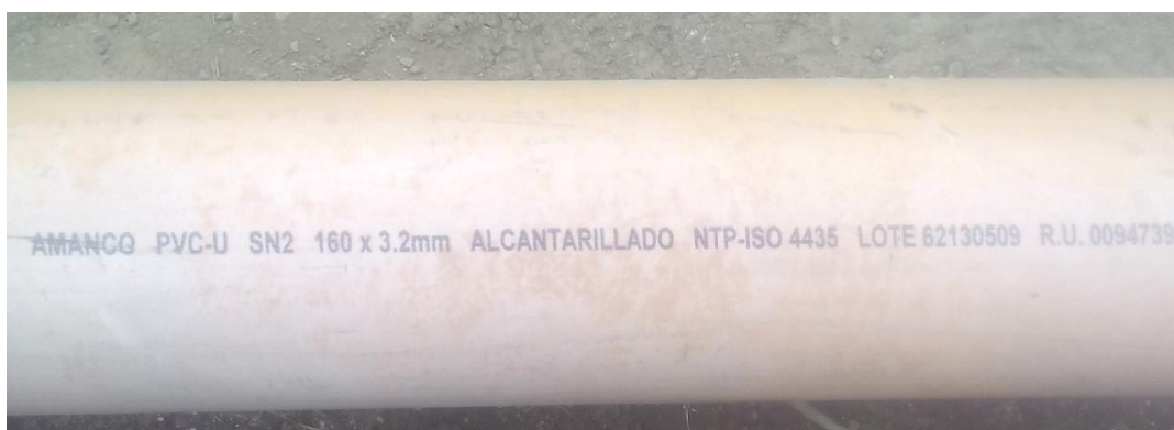
Figura 7. Tubería de PCV
