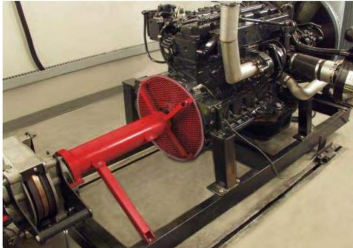
*Ilustración 5. Banco de ensayos de motores en donde está acoplado de forma directo al eje.*
