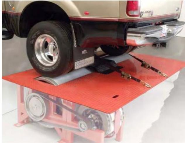
*Ilustración 4. Ejemplo de un Banco de Prueba de Chasis*
