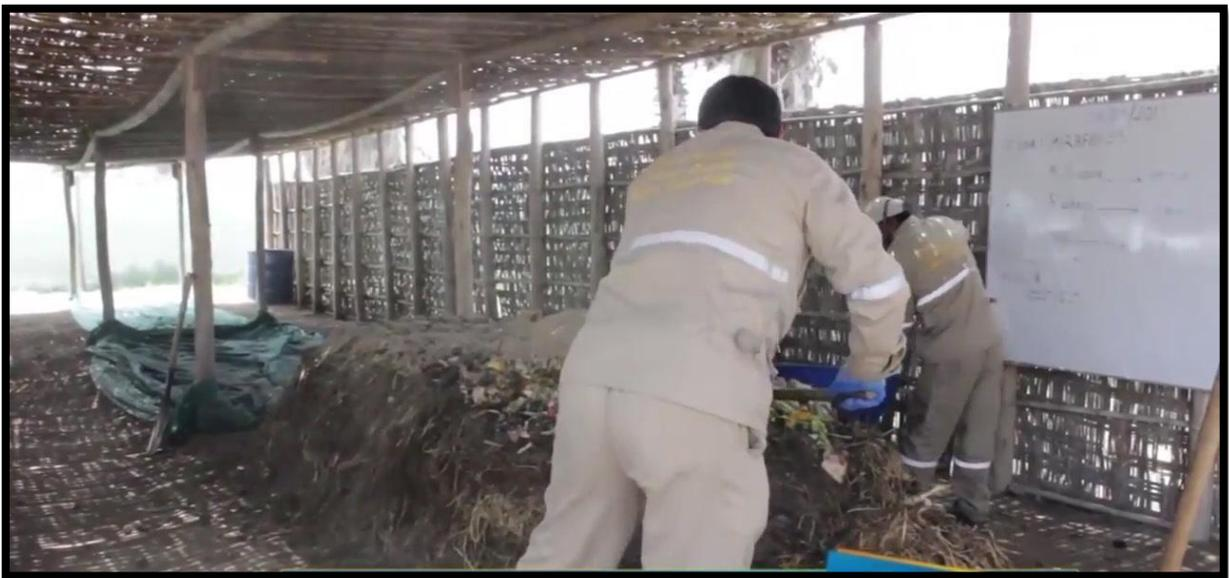
Figura N° 41: Mezclado de los residuos orgánicos con los materiales de rápida descomposición.
