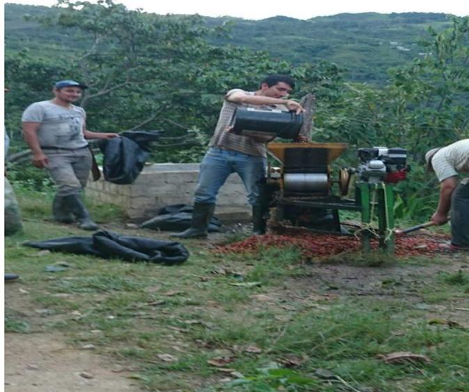
**Descripción:** Una vez recolectado el fruto maduro debe despulparse lo más pronto posible para evitar que comience la fermentación del grano; y se despulpa en una maquina llamada despulpadora que funciona con un motor pequeño.
