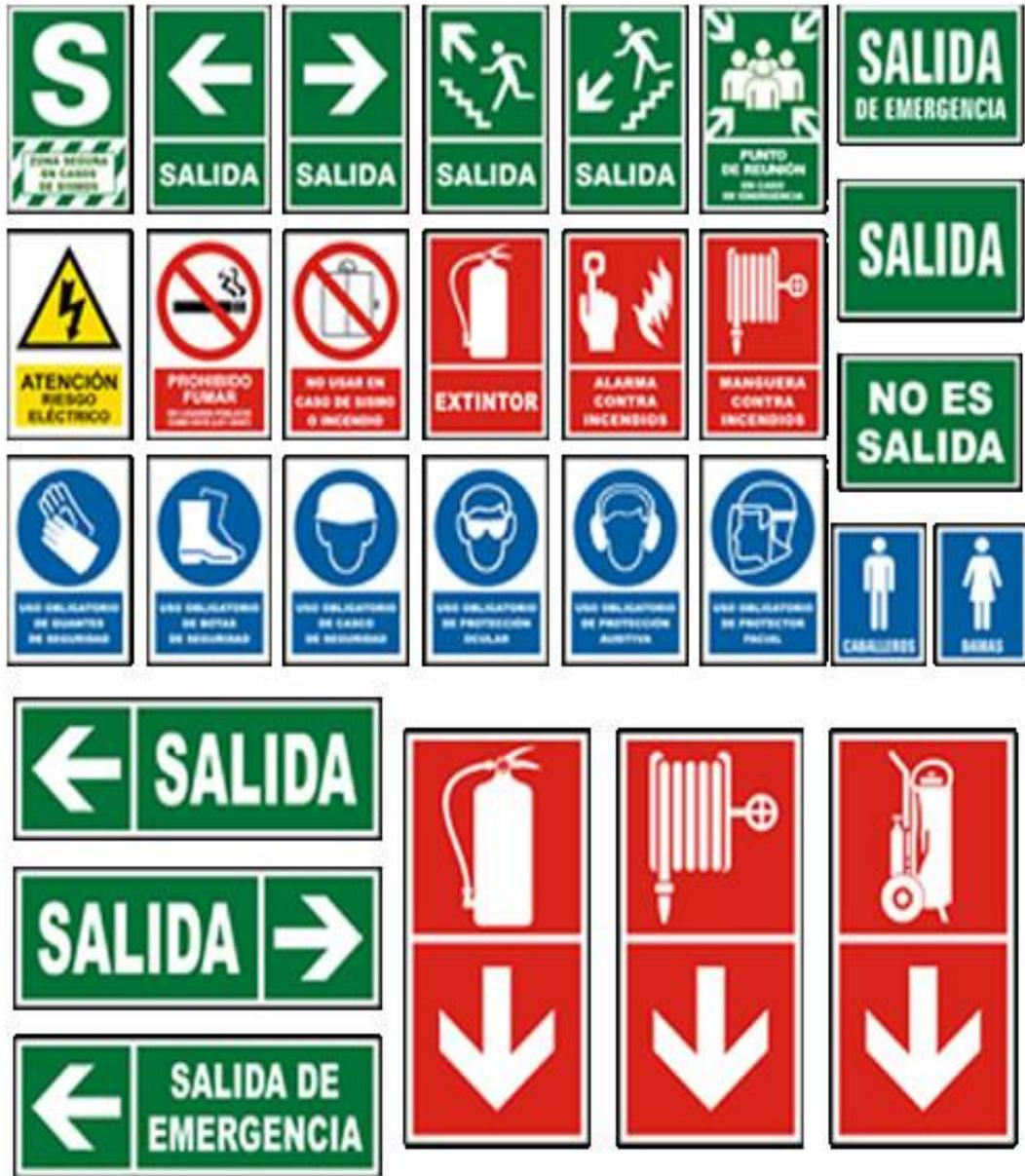
Figura 37. Señales bajo la NTP 399.010-1 (Norma Técnica Peruana de Señales de Seguridad)
