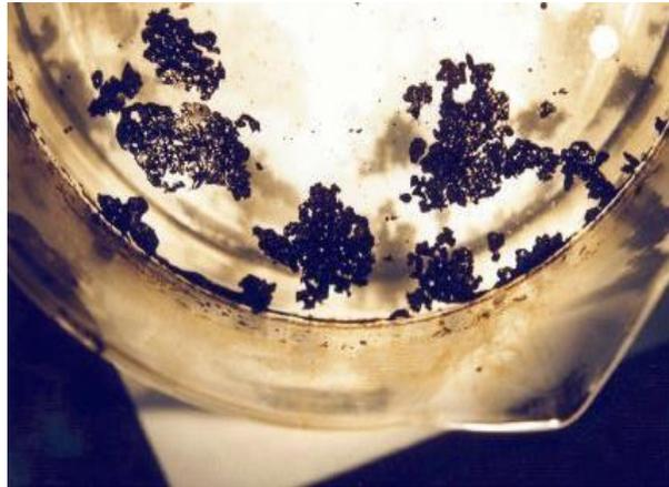
**Efecto del agregado surfactante. Derecha: la mancha de petróleo sin la emulsión de PBF, derecha: petróleo con emulsión agregada.**
