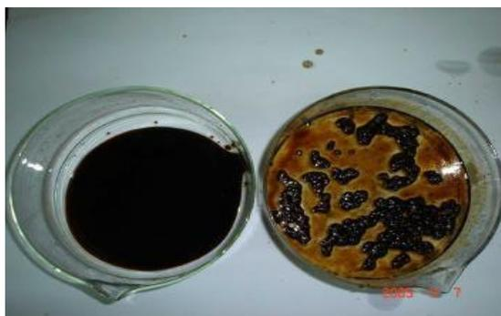
En la Figura en la Izquierda: 15 cm<sup>3</sup> de petróleo crudo desparramado sobre agua en una cápsula de Petri. Derecha: 15 cm<sup>3</sup> de petróleo crudo más 10 cm<sup>3</sup> de emulsión cremosa sobre agua en una cápsula de Petri, sin agitación, situación inicial.
