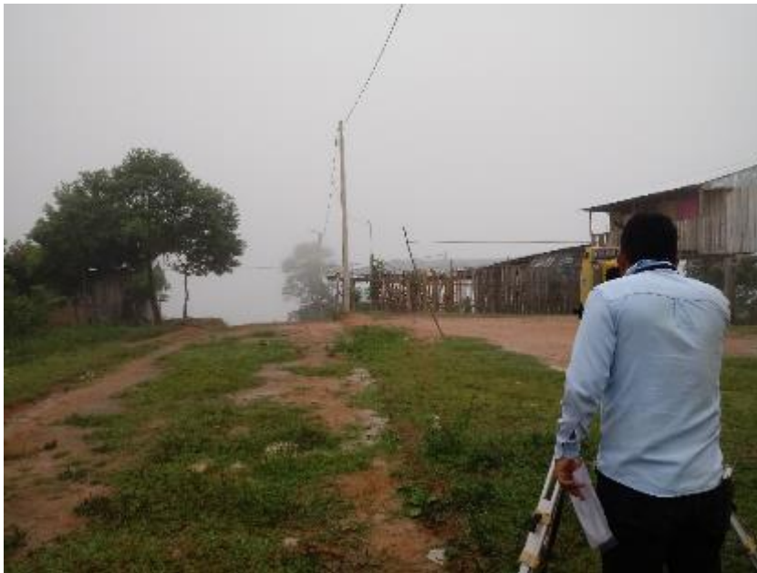
Toma de puntos en la localidad del mirador, utilizando para ello la estación Es-105
