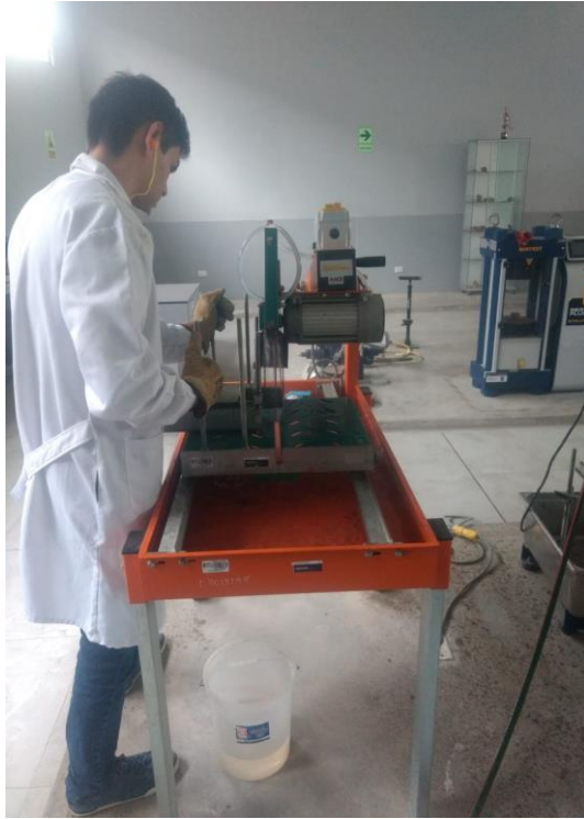
Extracción de testigos
