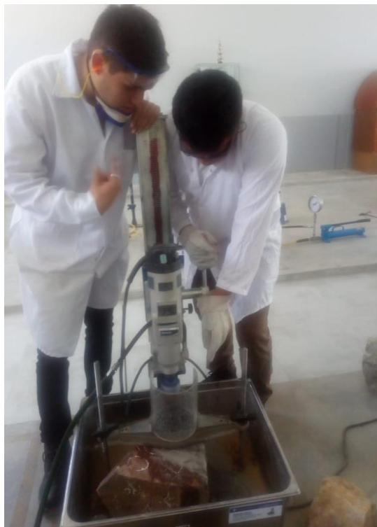
Extracción de testigos para los ensayos de laboratorio
