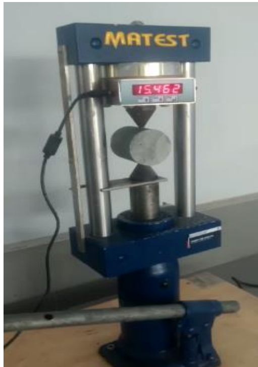
Muestras sometidas a ensayo compresión simple
