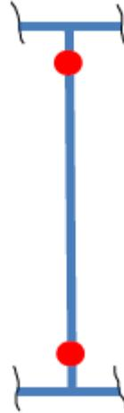
*Figura 82. Longitud plástica en elementos columnas, Hospital Naylamp.*
