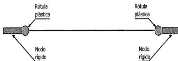
**Figura 1.23** Idealización de daño equivalente (Rotula Plástica)
