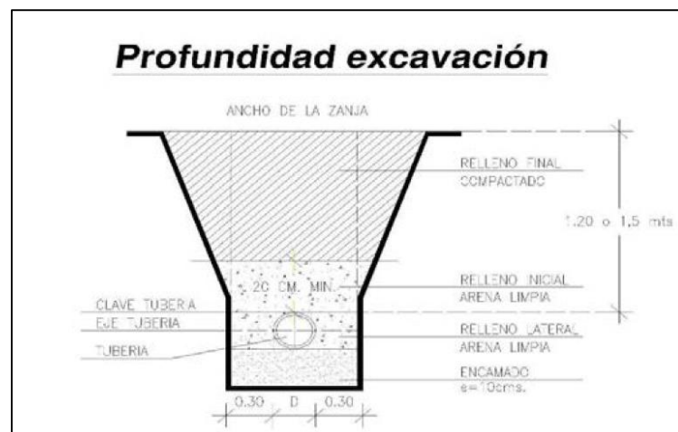
Figura 16 Perfil en alcantarillado por vacío (AIRVAC)
