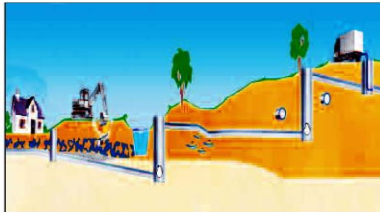
Figura 19 perfil de alcantarillado convencional. Fuente: Terraigua
