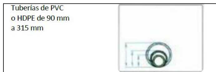
Figura 21 tubería para red de vacío
