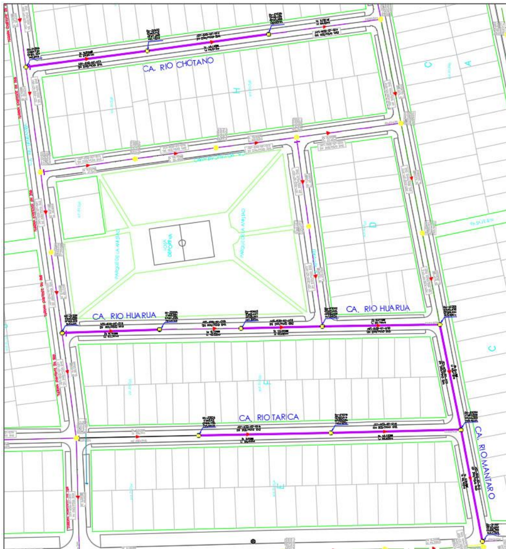
Figura 13: Tramos intervenidos en método Cracking
