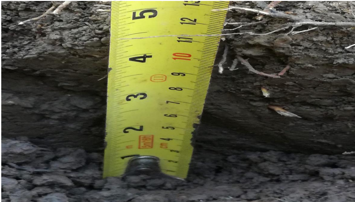
Fotografía 8: Profundidad de excavación (10cm)
