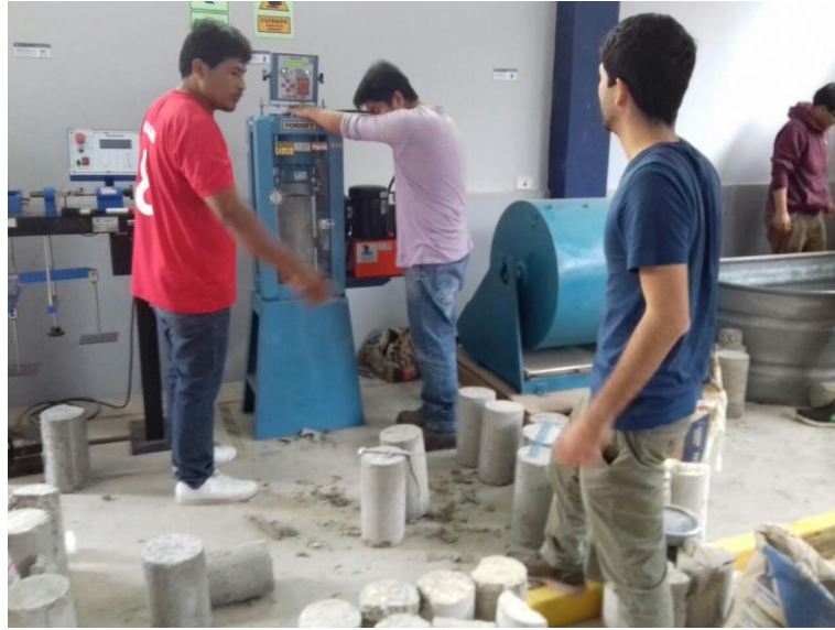
Figura 39: Proceso de aplicación de carga a la probeta en el ensayo de rotura.
