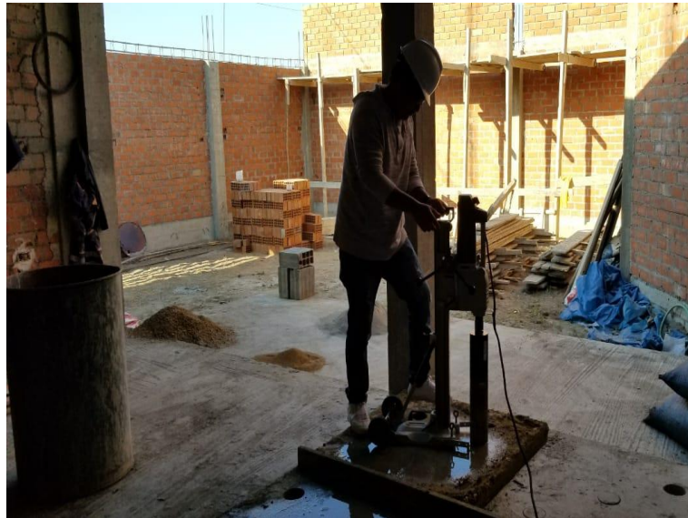
Figura 36: Extracción de testigo con diamantina losa curada con arrocera
