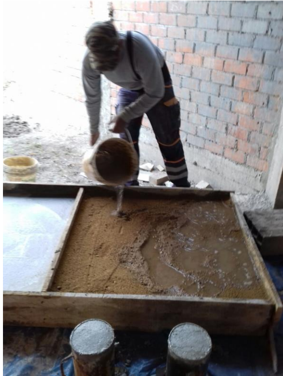
Figura 21: Proceso de curado con arena.
