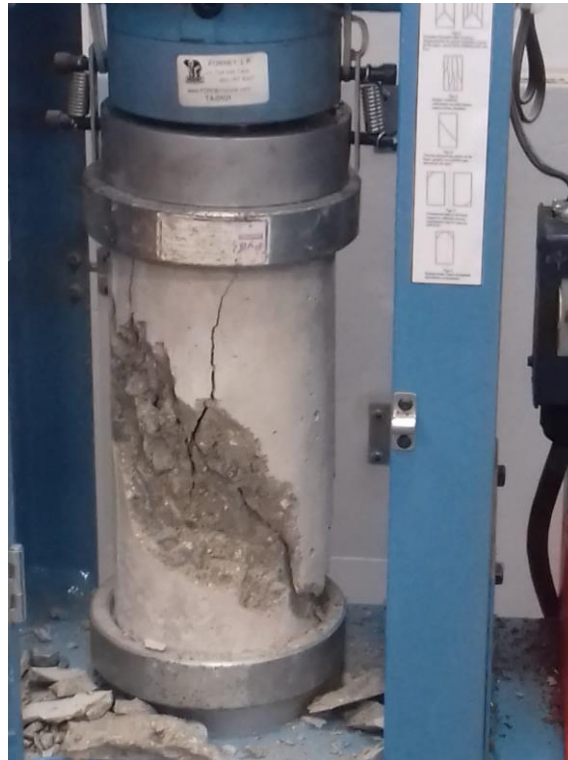
Figura 40: Vista de líneas de falla en la probeta ensayada.
