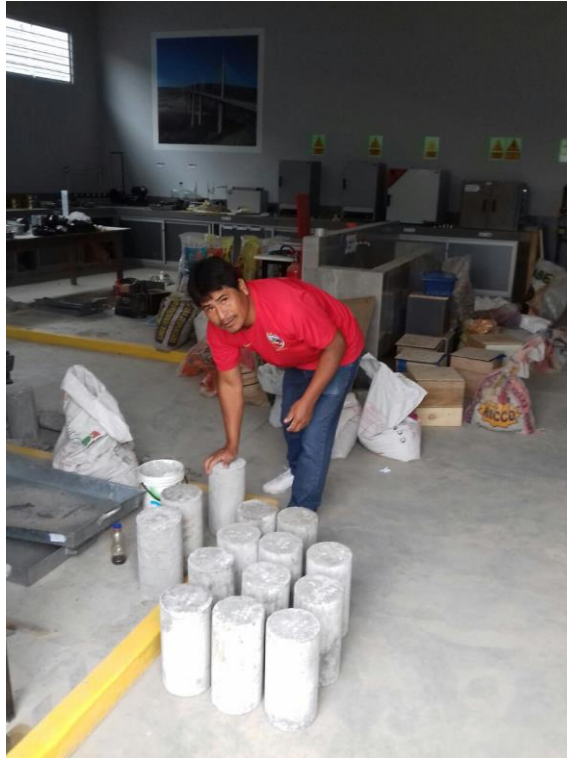
Figura 33: Habilitación de probetas para el ensayo de rotura.
