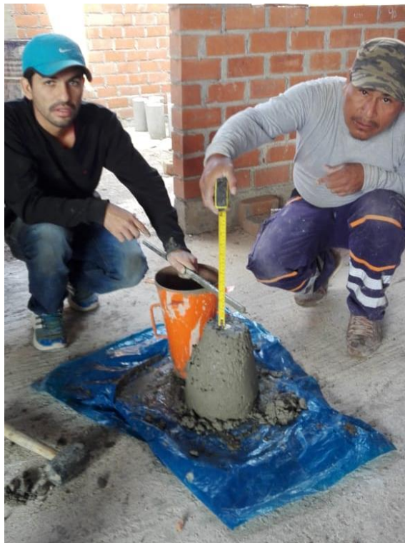
Figura 30: Verificación de medida en el ensayo de asentamiento.
