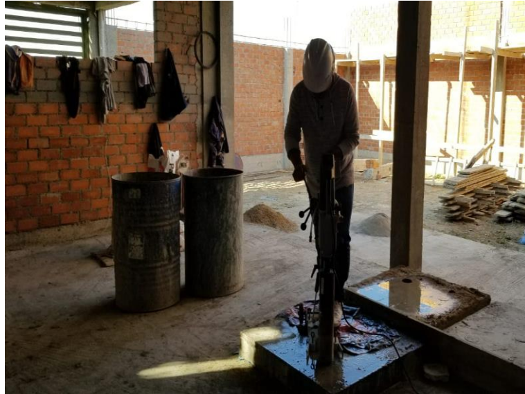
Figura 35: Extracción de testigo con diamantina losa curada con papel
