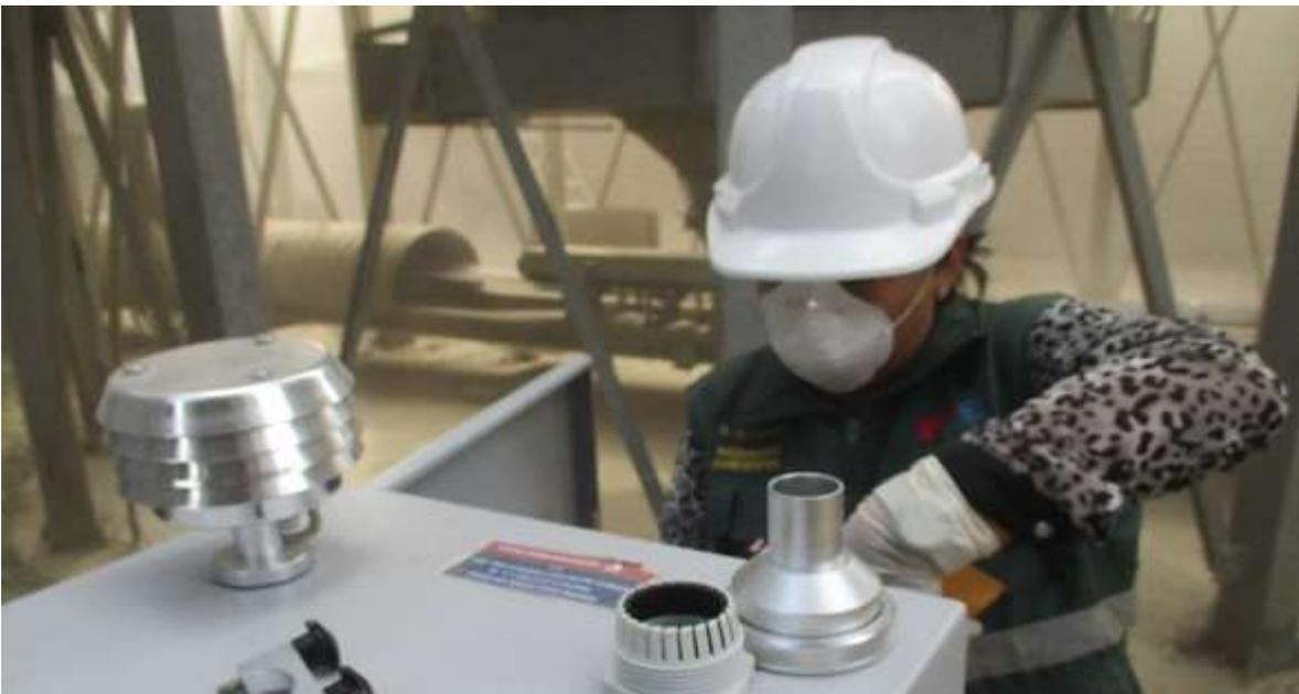
**Fotografía 2:** Instalación del muestreador de partículas  $PM_{2.5}$ , en el primer punto de monitoreo (Área de secado), de la piladora Rey León S.A.C.
