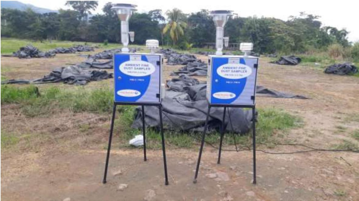
**Fotografía 11:** Inicio del monitoreo de material particulado  $PM_{10}$  y  $PM_{2.5}$ , en el Área de secado del molino Santa Clara.
