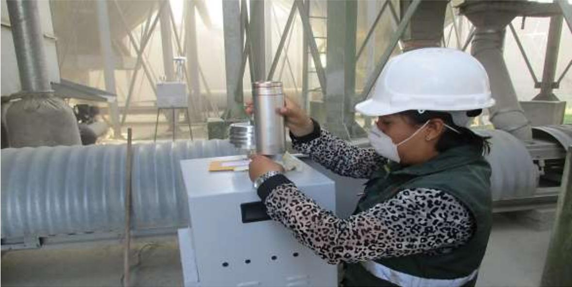
**Fotografía 1:** Instalación del muestreador de partículas  $PM_{10}$ , en el primer punto de monitoreo (Área de secado), de la piladora Rey León S.A.C.
