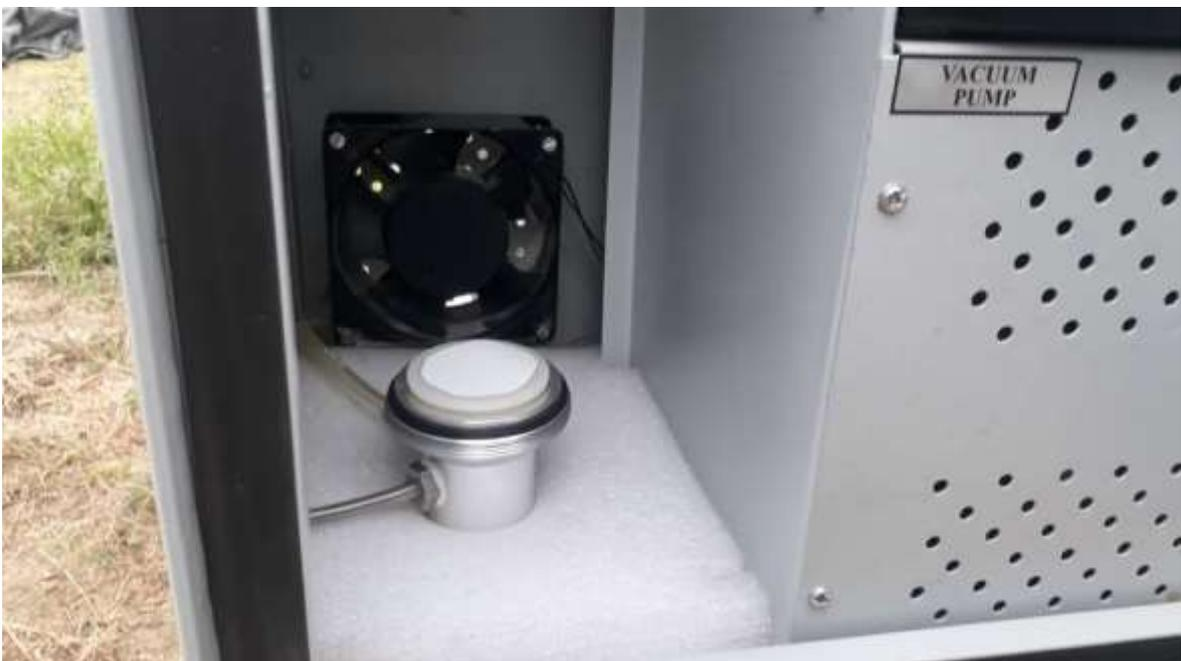
**Fotografía 10:** Colocación del filtro circular de cuarzo, en porta filtro del equipo.
