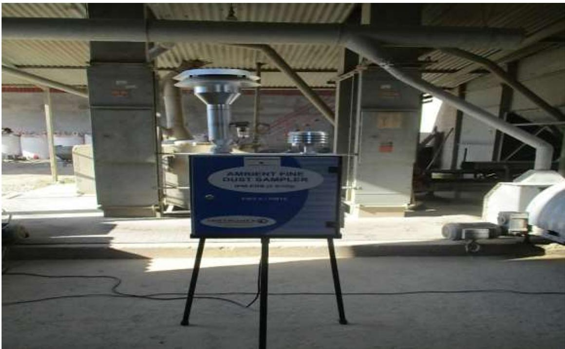
**Fotografía 4:** Inicio del monitoreo de material particulado  $PM_{10}$  y  $PM_{2.5}$ , en el Área de secado.
