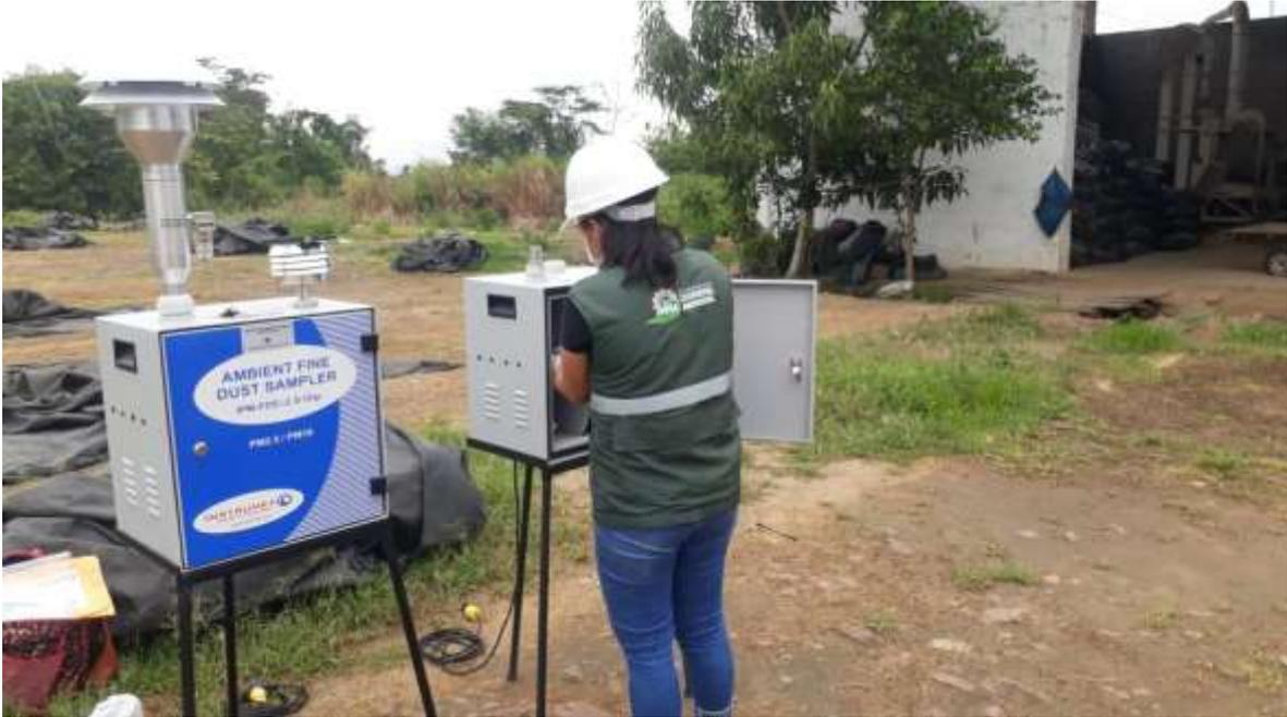
**Fotografía 9:** Instalación del muestreador de partículas  $PM_{2.5}$  en el área de secado del molino Santa Clara.
