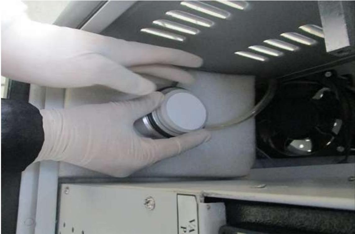
**Fotografía 3:** Colocación del filtro circular de cuarzo, en porta filtro del equipo.
