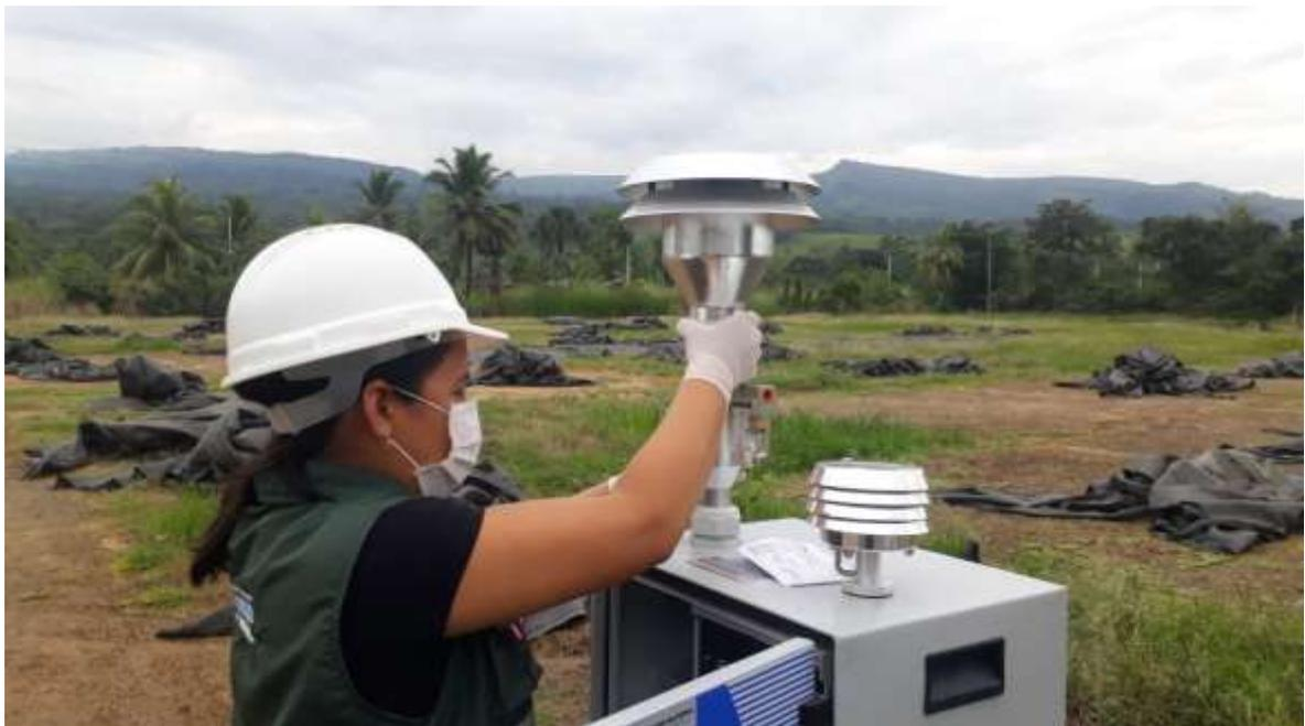
**Fotografía 8:** Instalación del muestreador de partículas  $PM_{10}$  en el área de secado del molino Santa Clara.
