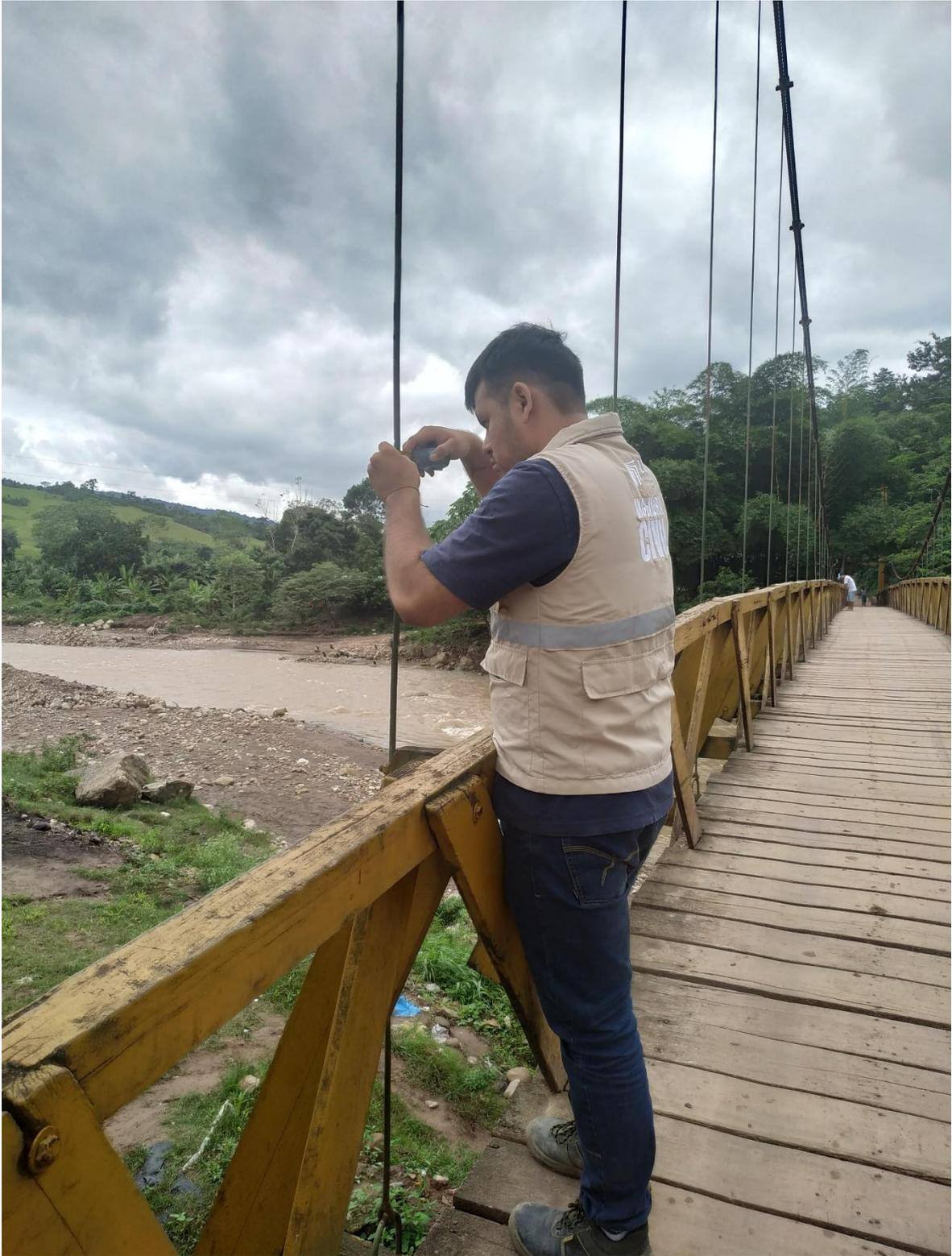
**Foto N° 11:** Se puede apreciar en la fotografía tomando medida de la péndola, siendo este un dato importante para el modelamiento.
