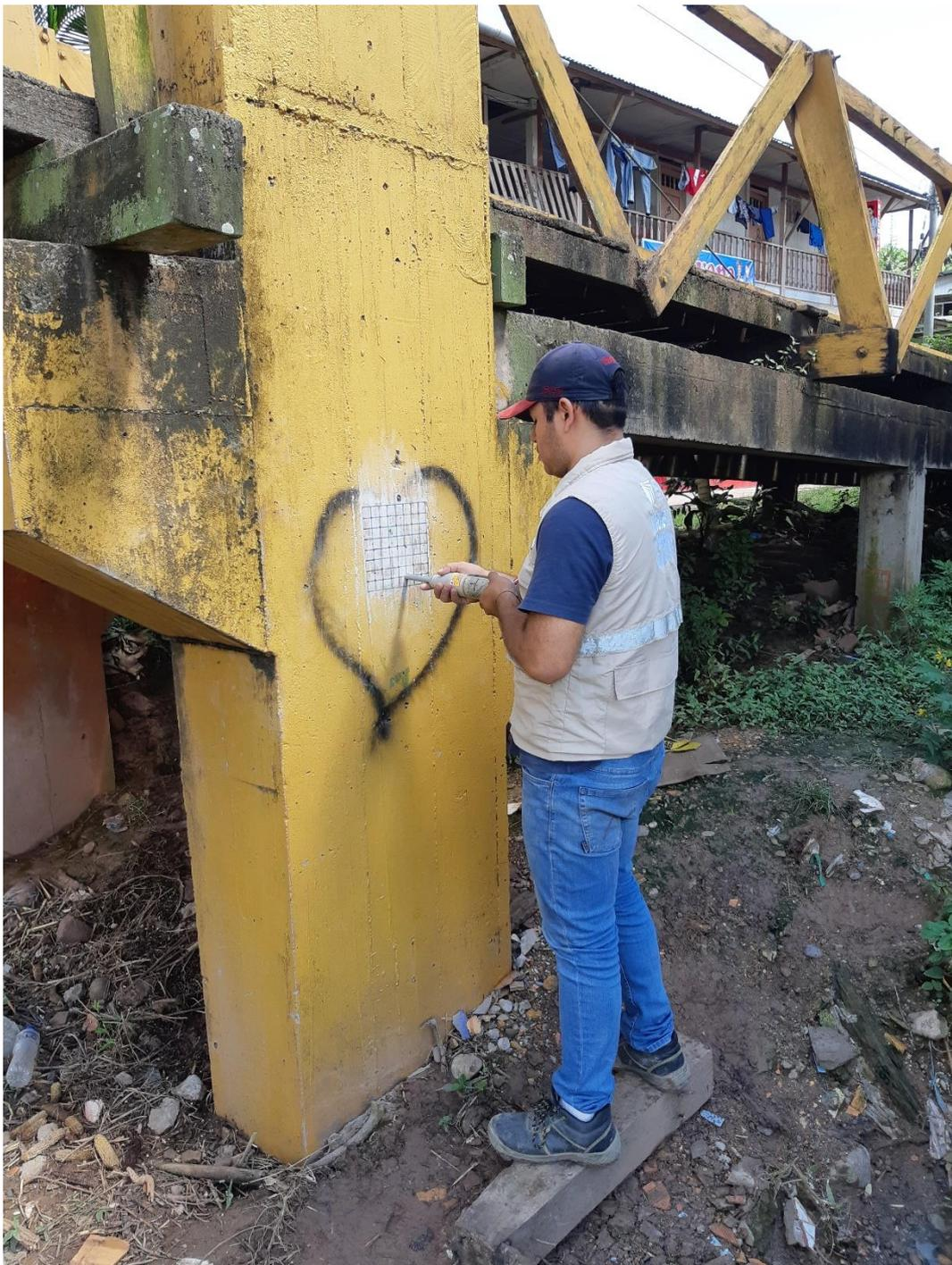
**Foto N° 08:** Aplicando el ensayo de Esclerometro en el margen derecho del rio ponaza.
