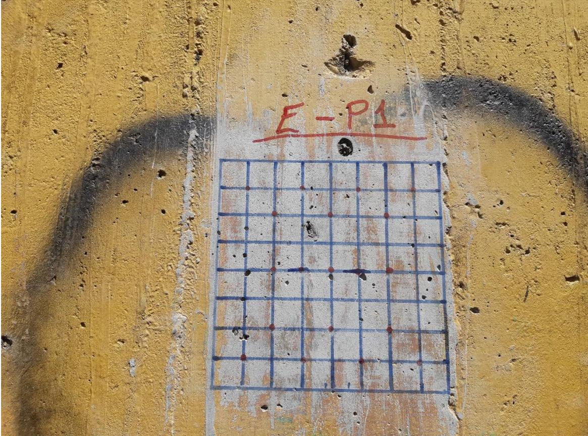
**Foto N° 07:** Cuadro donde se aplicó el Esclerómetro obteniendo 16 resultados.
