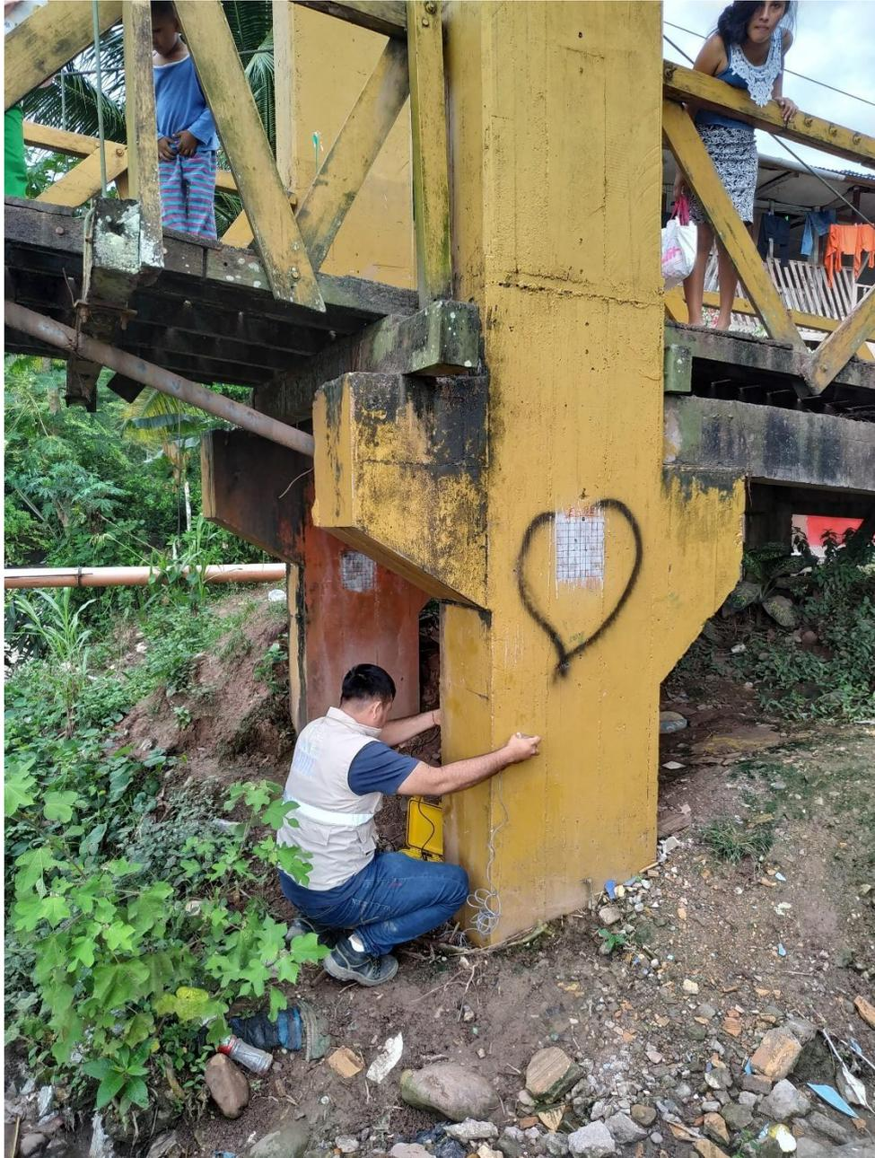
**Foto N° 05:** Evaluando mediante pulsaciones de la columna de 40x75 cm del margen derecho del rio ponaza.
