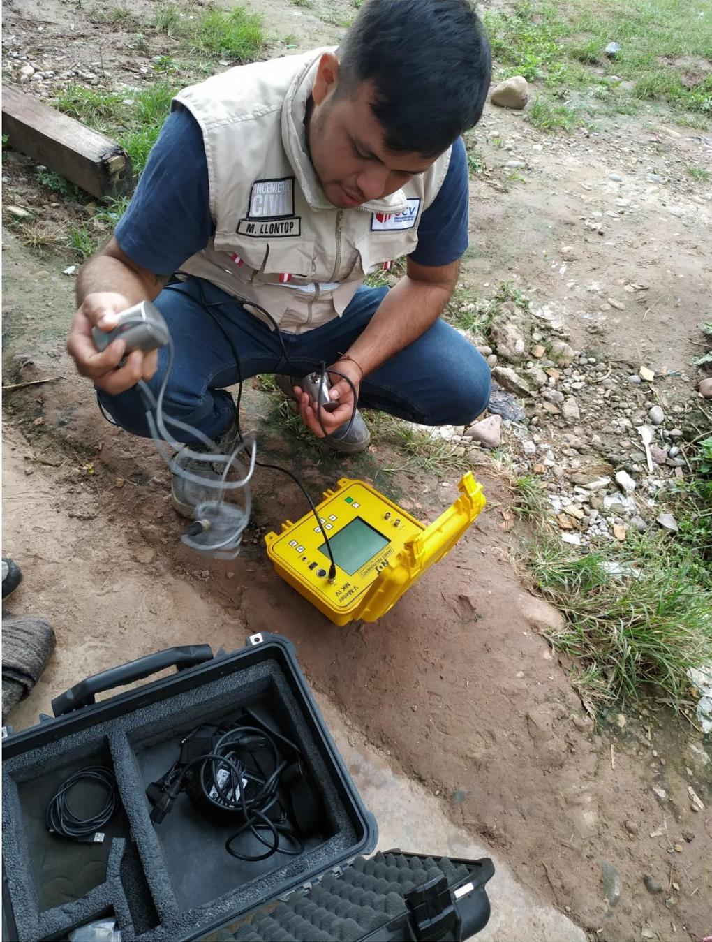
**Foto N° 03:** Calibrando el equipo de ultrasonido para la evaluación de las torres
