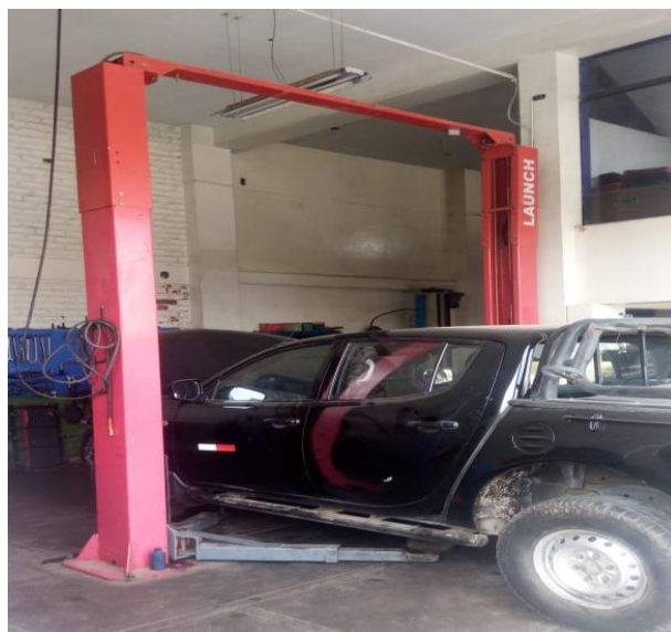
Figura 19. Elevador hidráulico tipo arco 4 TM, marca LAUNCH
