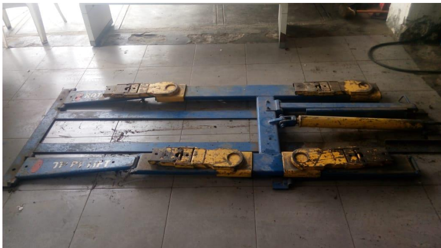
Figura 21. Elevador hidráulico tipo rampa 4 TM, marca ROTARY
