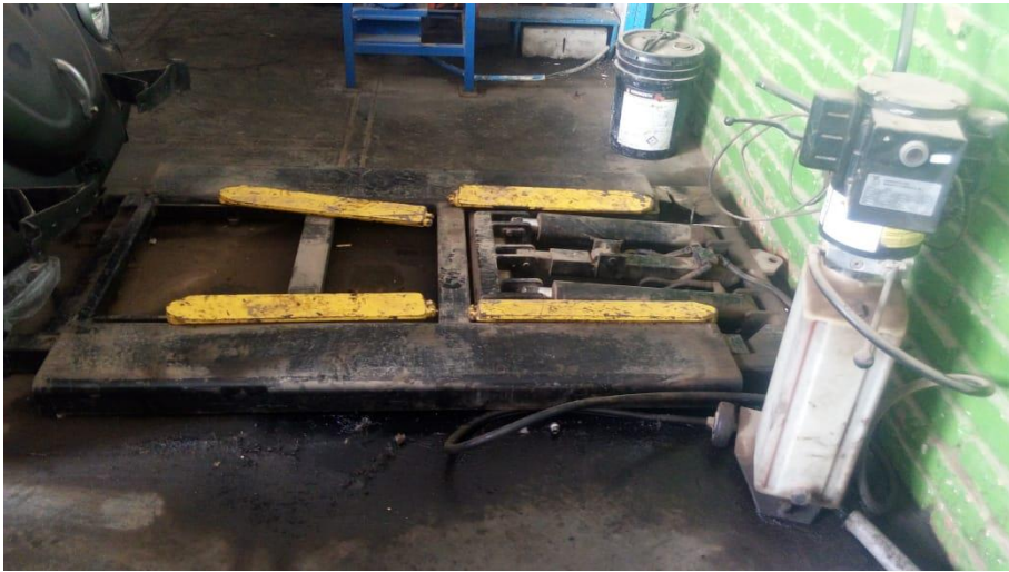
Figura 22. Elevador hidráulico tipo rampa 4 TM, marca ROTARY
