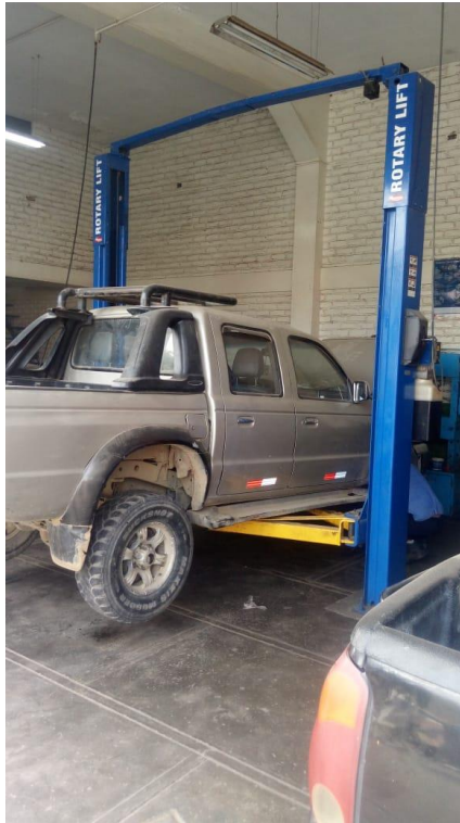
Figura 20 . Elevador hidráulico tipo arco 4,5 TM, marca ROTARY
