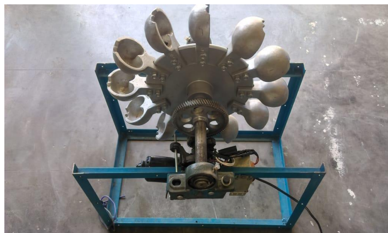
Imagen 12 sistema de transmisión de motor con turbina
