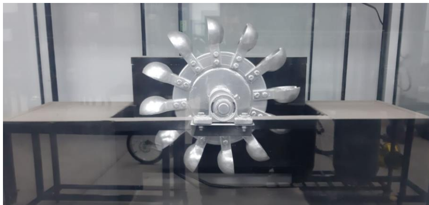
Imagen 11 Alabes de turbina pelton
