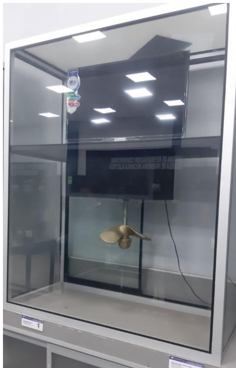
Imagen 16 modulo instalado de turbina Kaplan en laboratorio
