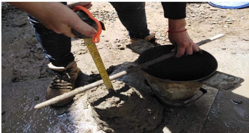
**Figura 53.** *Ensayo de slump del concreto patrón y vidrio triturado.*
