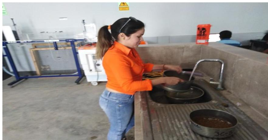
**Figura 36 .** Ensayo normalizado por lavado - agregado fino.
