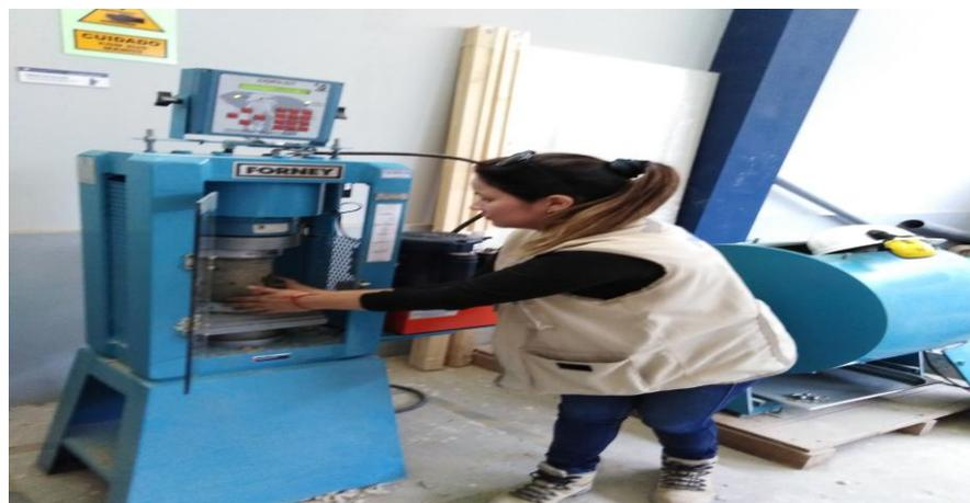
**Figura 60.***Ensayo a compresión de probetas.*
