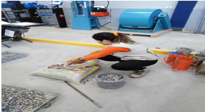
**Figura 41.** *Ensayo de peso unitario de agregado grueso (suelto y varillado).*
