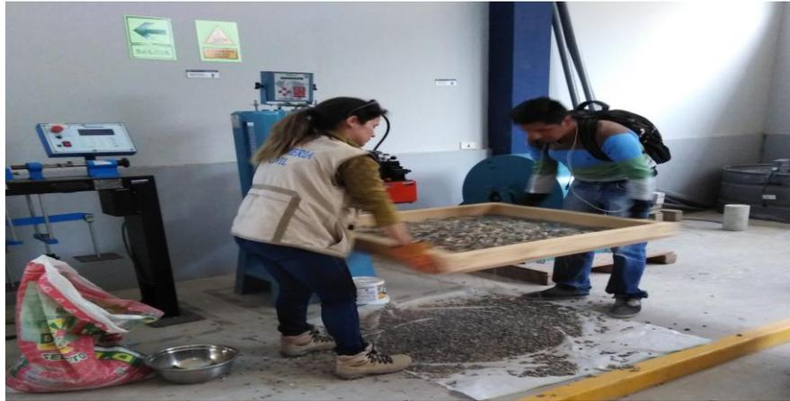
**Figura 37.** *Tamizado del agregado grueso.*
