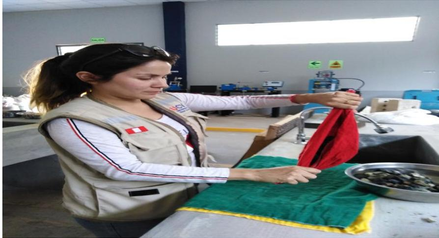
**Figura 43.** *Ensayo de peso específico y absorción de agregado grueso.*
