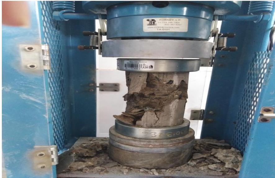
**Figura 61.** Rotura de probetas de concreto.
