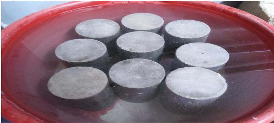
**Figura 59.***Curado de probetas de concreto.*
