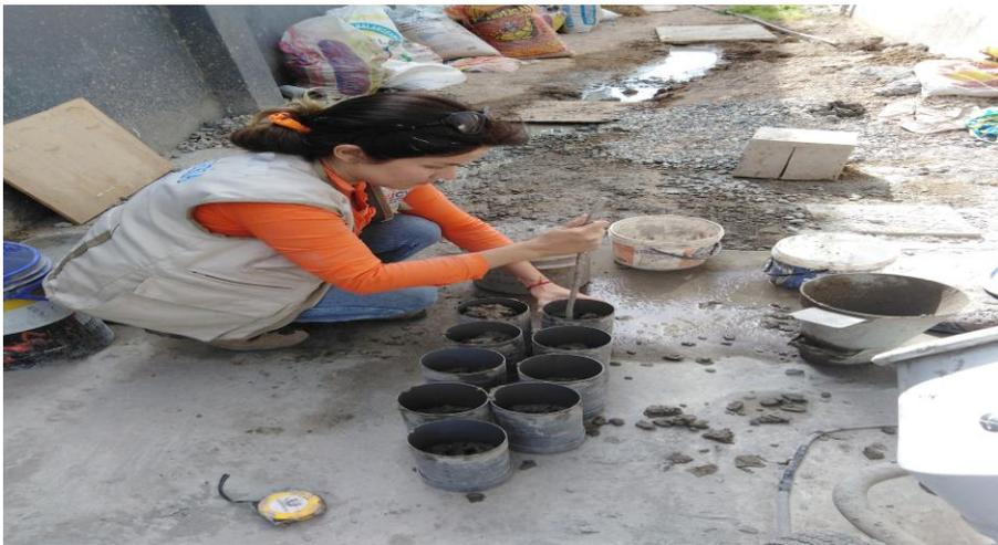
**Figura 56.** Elaboración de probetas.
