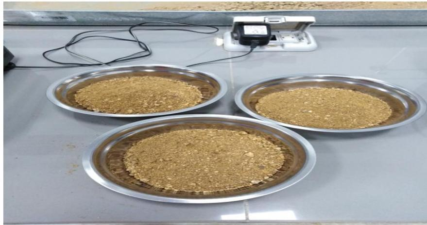
**Figura 38.** *Ensayo de contenido de humedad de agregado fino.*
