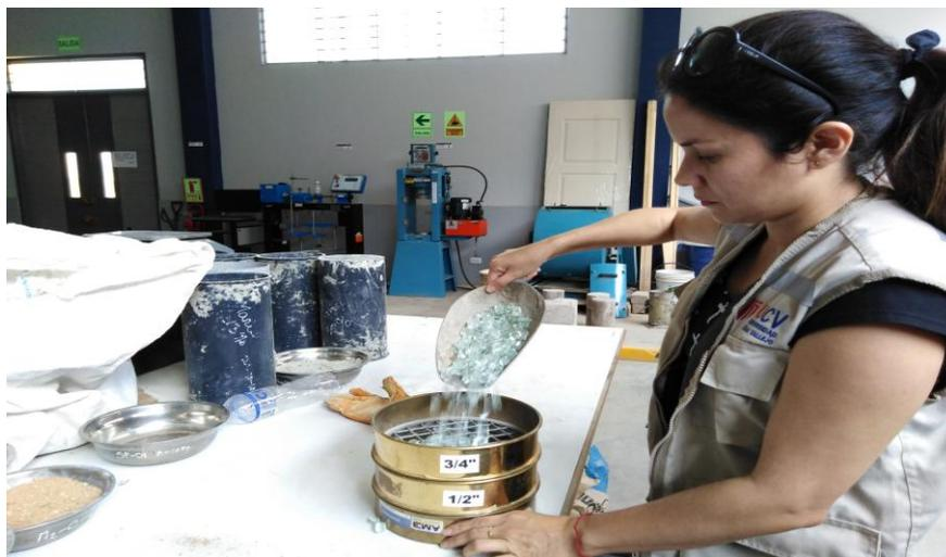
**Figura 48.** Tamizado de vidrio triturado (templado) por la malla  $\frac{3}{4}$ " y  $\frac{1}{2}$ ".
