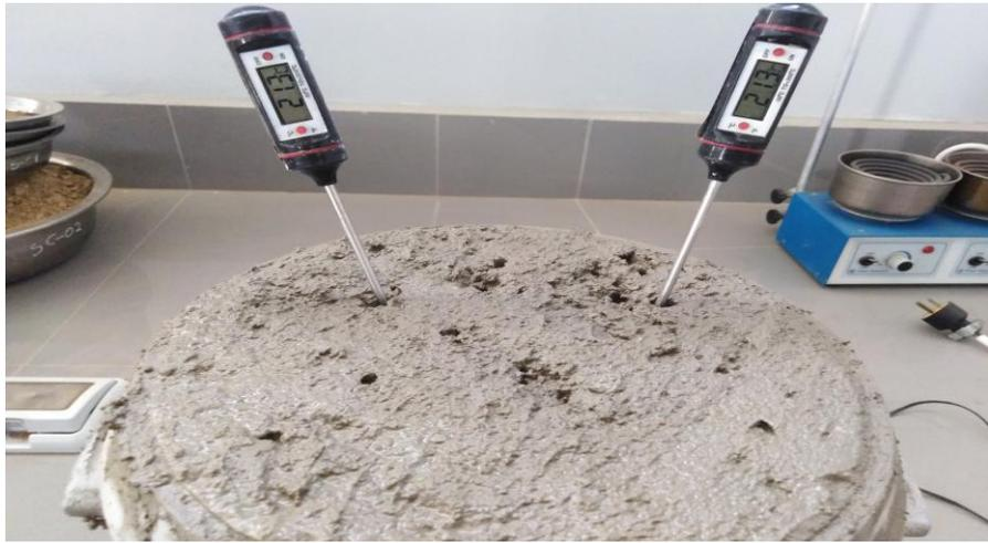
**Figura 55.** Toma de temperatura de concreto fresco.
