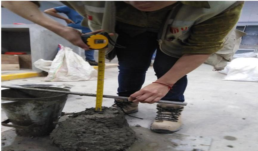
**Figura 52.** *Ensayo de slump del concreto patrón.*
