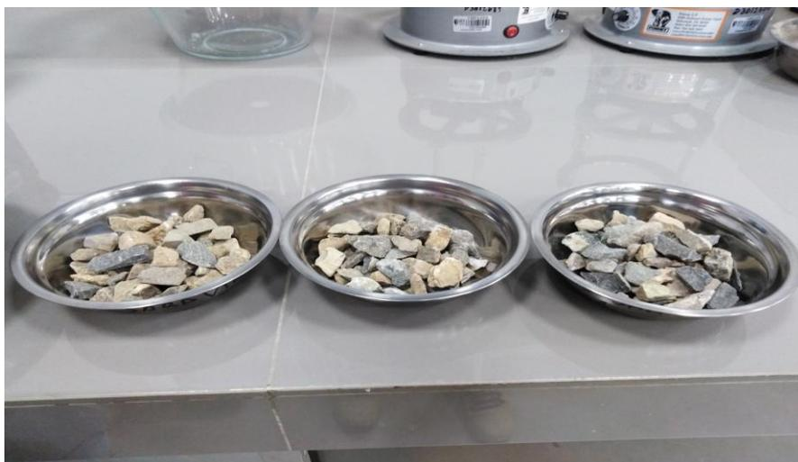
**Figura 39.** *Ensayo de contenido de humedad de agregado grueso.*
