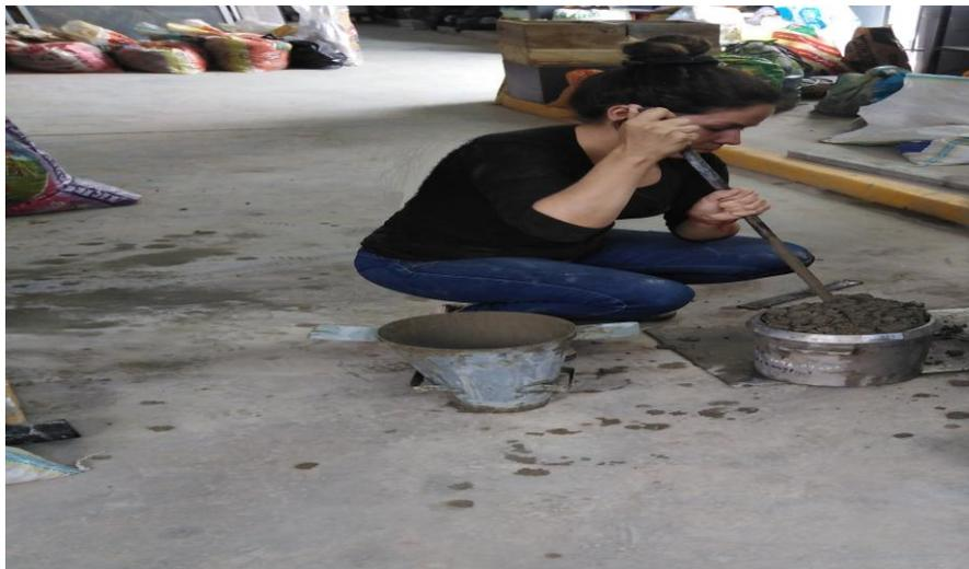
**Figura 54.** *Ensayo de peso unitario de concreto.*
