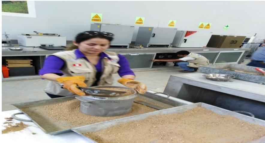
**Figura 40.** *Ensayo de peso unitario de agregado fino (suelto y varillado).*
