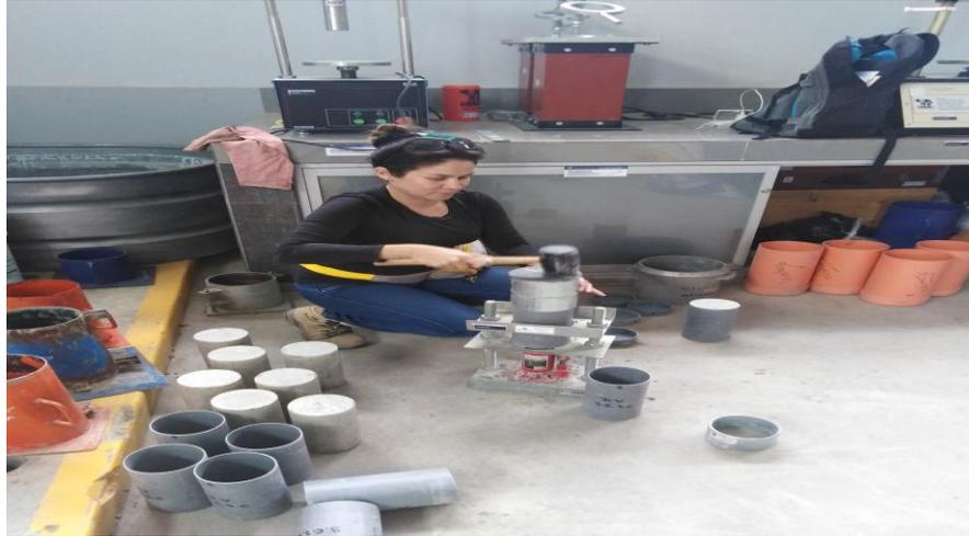
**Figura 58.***Desmolde de probetas de concreto.*
