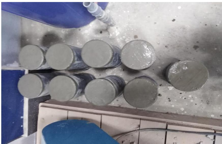
**Figura 57.** Secado de probetas de concreto.
