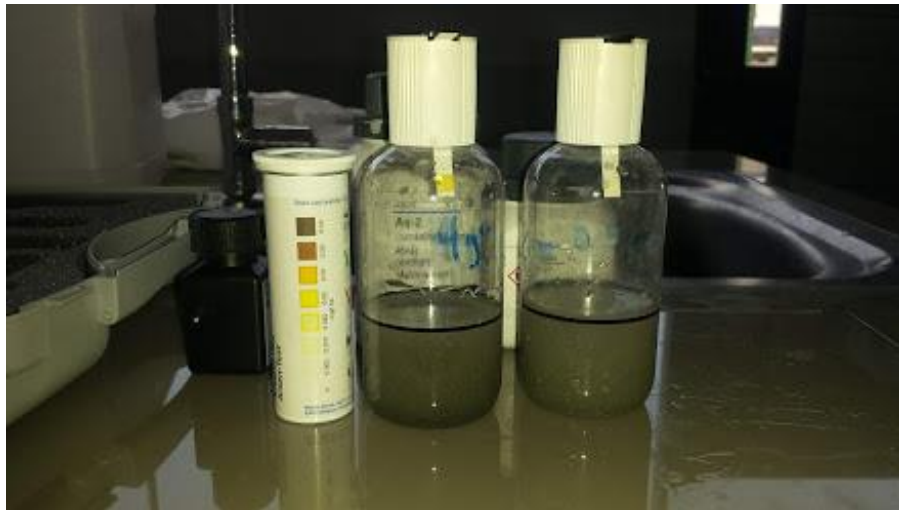
Imagen 12 Proceso de cuantificación de arsénico, se tiene que esperar un tiempo de 20 min para obtener resultados.
