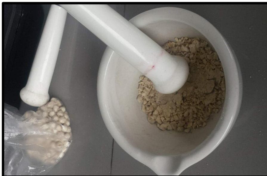
Imagen 5 Coagulante en Polvo de semillas de Moringa oleifera
