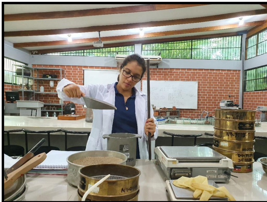
FOTO 04. Ensayo de Peso Unitario Compactado según ASTM – 29 de la muestra de agregado fino
