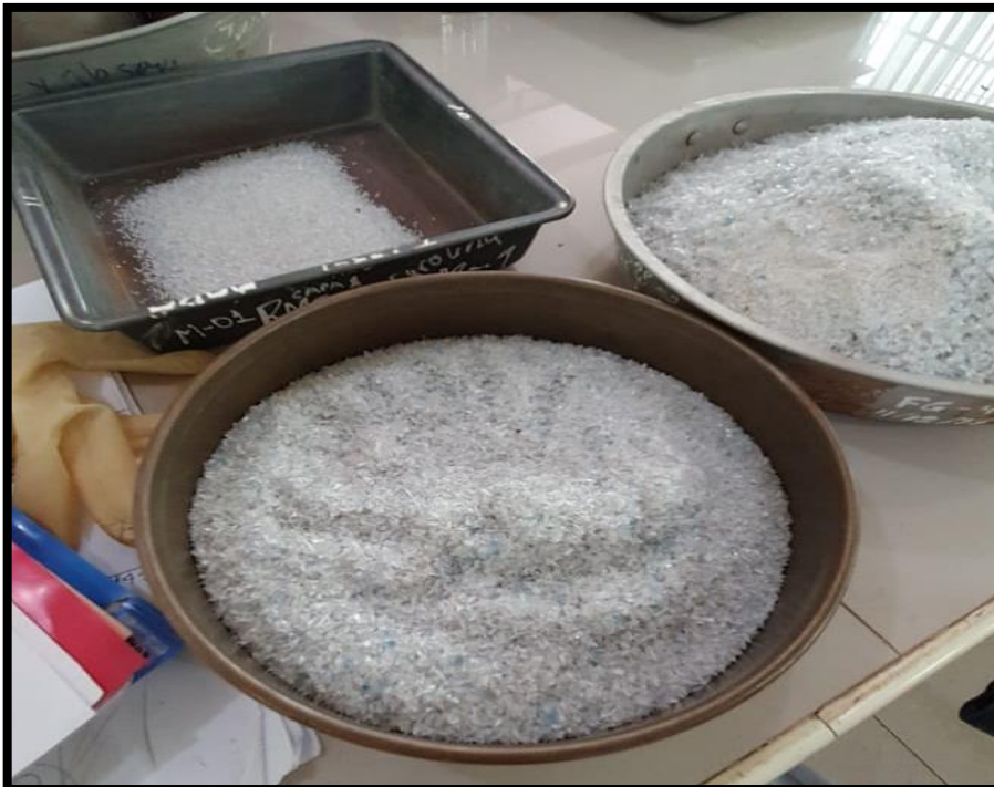
FOTO 10. Clasificación de polietileno tereftalato según porcentaje de retenido en las mallas de granulometría.
