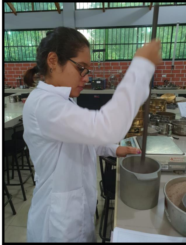
FOTO 03. Ensayo de Peso Unitario Compactado según ASTM – 29 de la muestra de agregado fino
