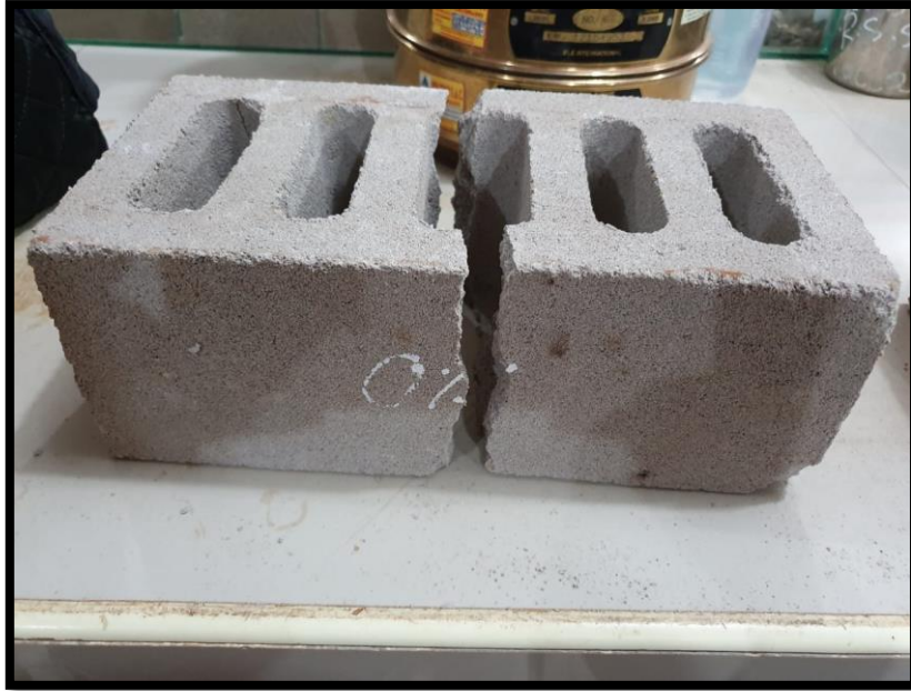
FOTO 19. Falla en el ladrillo patrón King Kong tipo 14 sometido a resistencia a la compresión individual f'b
