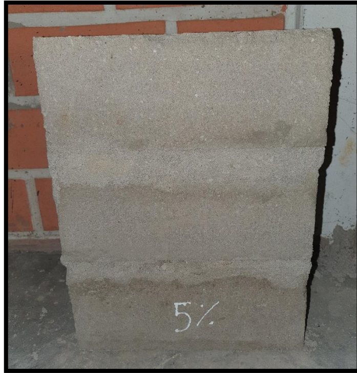
FOTO 23. Pila de ladrillo King Kong tipo 14 con 5% de Polietileno tereftalato.
