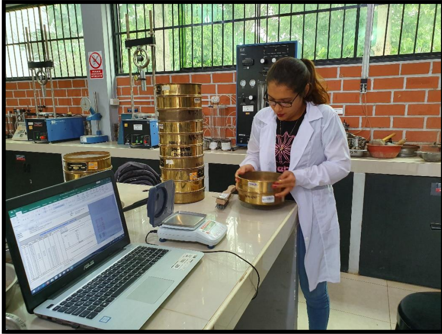
FOTO 01. Ensayo de granulometría para la determinación de propiedades físicas del agregado fino (arena gruesa del río Cumbaza TM 3/8")
