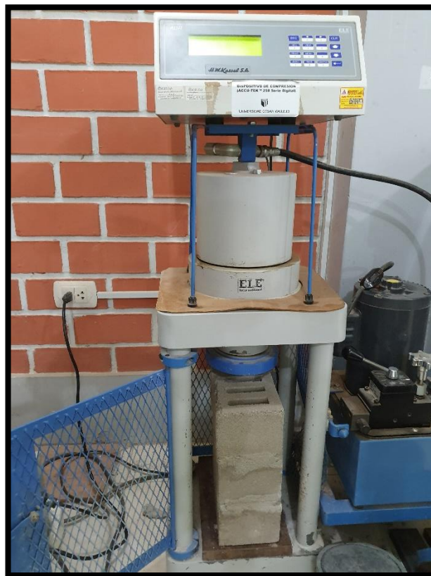
FOTO 26. Ensayo de compresión a las pilas de ladrillo King Kong tipo 14 con PET.
