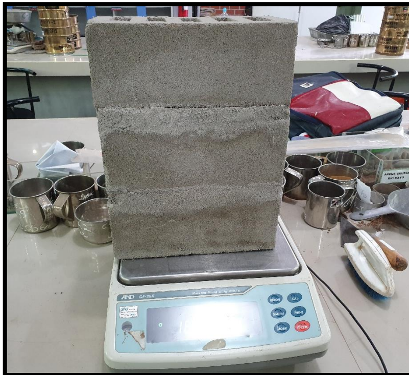
FOTO 24. Peso de pila de ladrillo King Kong tipo 14 con 10% PET.
