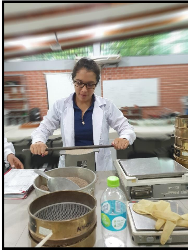
FOTO 05. Ensayo de Peso Unitario Compactado según ASTM – 29 de la muestra de agregado fino
