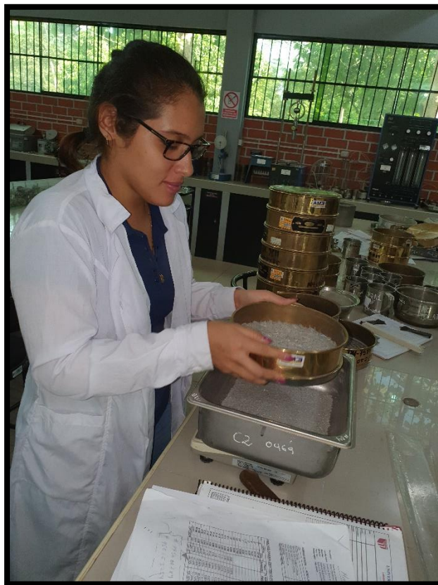
FOTO 02. Tamizado de material agregado fino por la malla N° 04 para determinación de muestra para Peso Unitario
