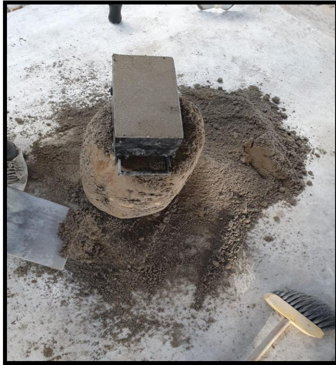
FOTO 15. En proceso de elaboración de las unidades de albañilería King Kong tipo 14 por dosificación
