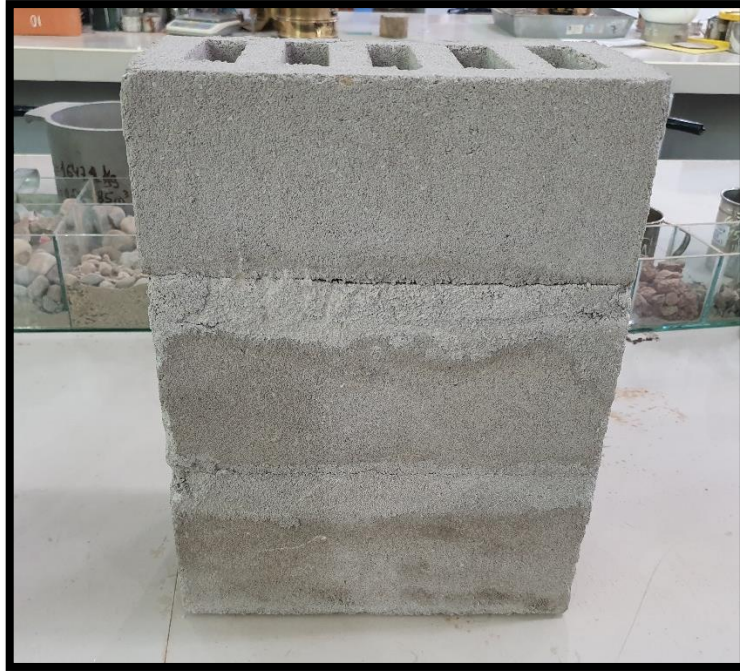
FOTO 25. Pila de ladrillo King Kong tipo 14 con 15% PET.
