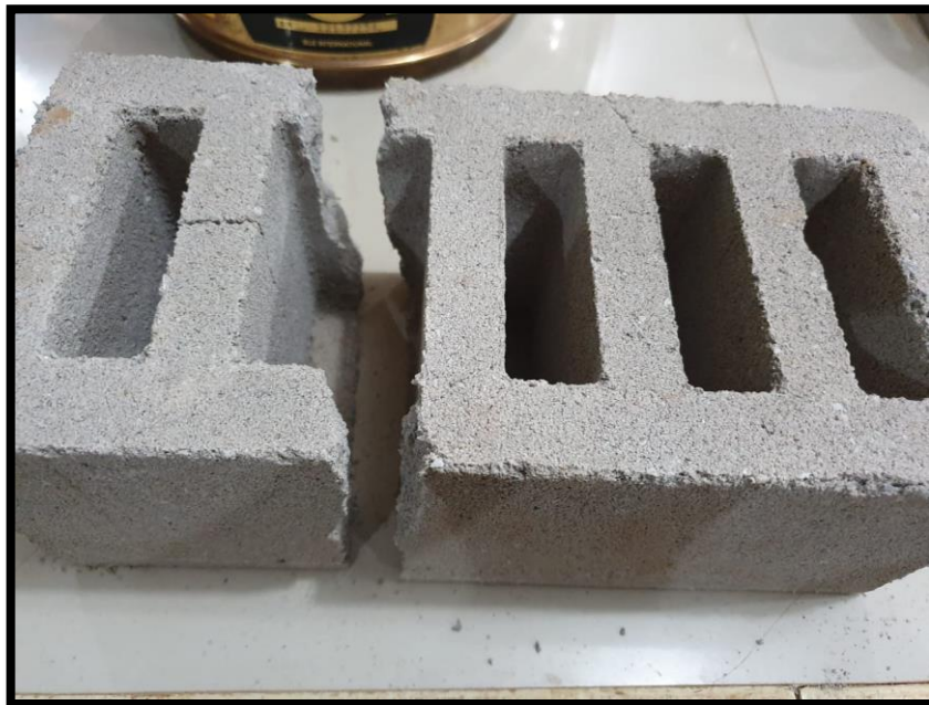
FOTO 19. Falla en el ladrillo patrón King Kong tipo 14 sometido a resistencia a la compresión individual f'b
