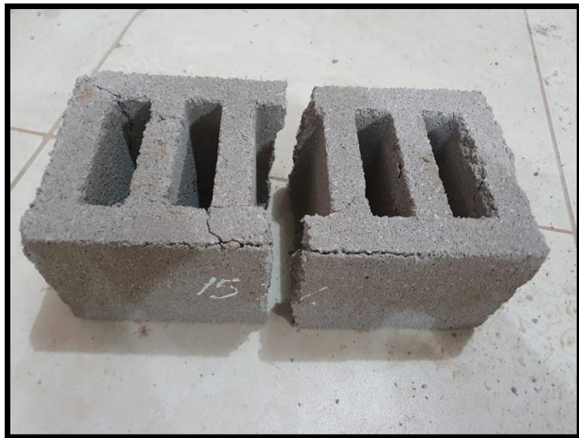
FOTO 21. Falla en el ladrillo patrón King Kong tipo 14 con 10% de PET sometido a la resistencia a la compresión individual f'_b
