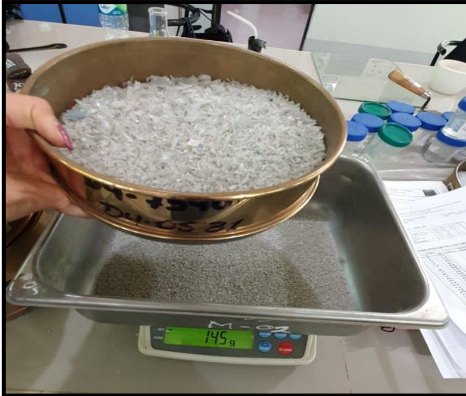
FOTO 09. Tamizado del polietileno tereftalato para su clasificación, por la malla N° 10
