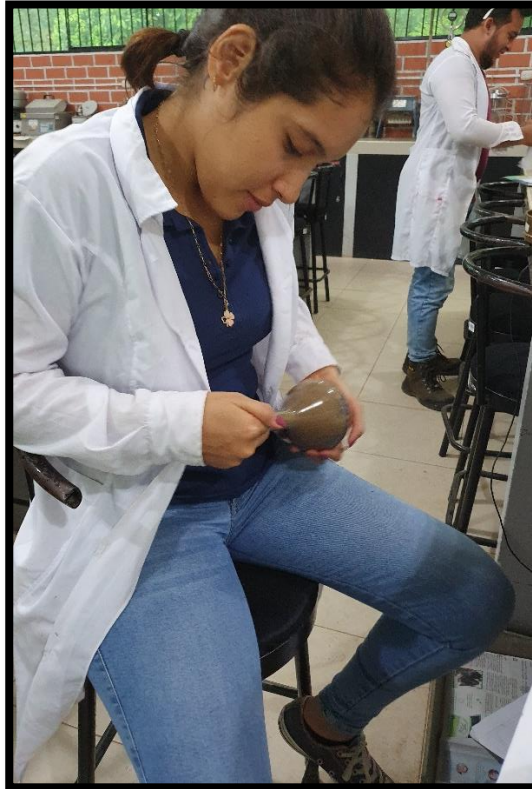
FOTO 07. Ensayo de peso específico en agregado fino.
