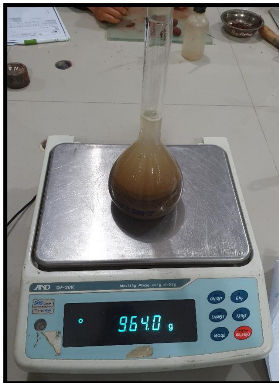
FOTO 08. Ensayo de peso específico en agregado fino.
