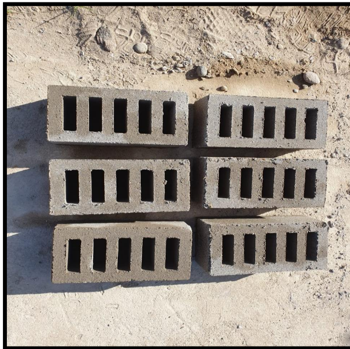
FOTO 16. Elaboración de los ladrillos King Kong tipo 14
