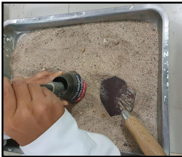
FOTO 06. Ensayo de cono de absorción de arenas al agregado fino.
