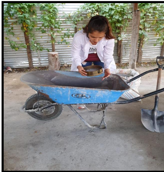
FOTO 12. Tamizado de polietileno tereftalato pasante por la malla N° 10
