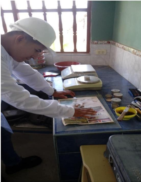
*FOTO 5:* Se observa al tesista realizando rollitos de diámetro 3.2 mm.
