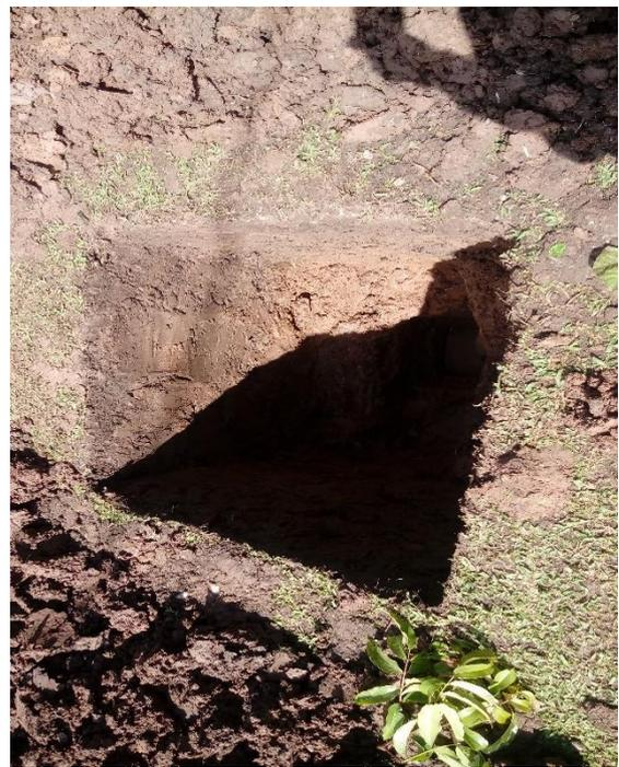
VISTA PANORÁMICA DE LAS PERFORACIONES A TAJO ABIERTO DE LAS CALICATAS N° 04, DONDE SE TOMARON LAS MUESTRAS PARA LOS ANÁLISIS Y PRUEBAS. DETERMINACIÓN DE LA HUMEDAD NATURAL “IN SITU”, DONDE SE OBSERVA AL ESTRATO SUPERIOR E INFERIOR ESTA CONFORMADO POR ARCILLA INORGÁNICA DE ALTA PLASTICIDAD.
