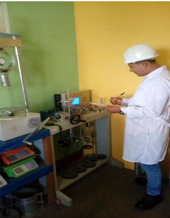
*FOTO 7:* Se observa al tesista realizando el ensayo de corte directo NTP – 339.171 (ASTM D-3080)
