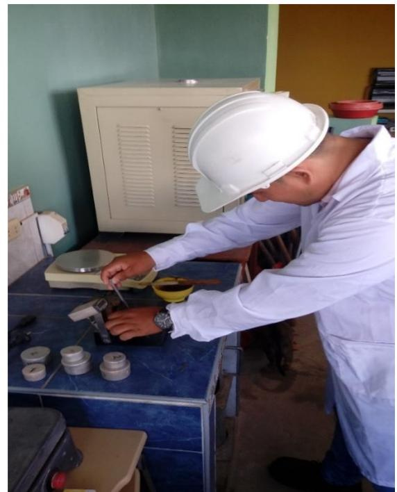
*FOTO 4:* Se observa al tesista pasando el acanalador (ranurador), por el centro de la copa, para cortar en 2 partes.
