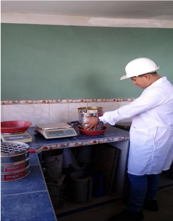
*FOTO 1:* Se observa al tesista realizando el análisis granulométrico por tamizado
