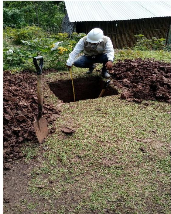
VISTA PANORÁMICA DE LAS PERFORACIONES A TAJO ABIERTO DE LAS CALICATAS N° 03, DONDE SE TOMARON LAS MUESTRAS PARA LOS ANÁLISIS Y PRUEBAS. DETERMINACIÓN DE LA HUMEDAD NATURAL “IN SITU”, DONDE SE OBSERVA AL ESTRATO SUPERIOR E INFERIOR ESTA CONFORMADO POR ARCILLA INORGÁNICA DE ALTA PLASTICIDAD.
