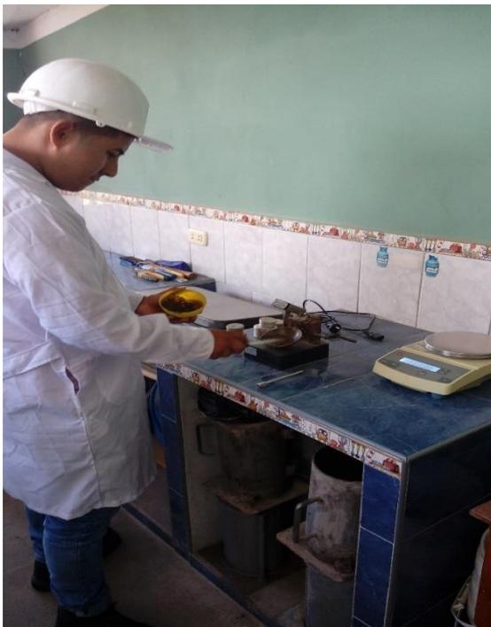
*FOTO 3:* Se observa al tesista realizando el ensayo del límite líquido NTP – 339.129 (ASTM C-4318)
