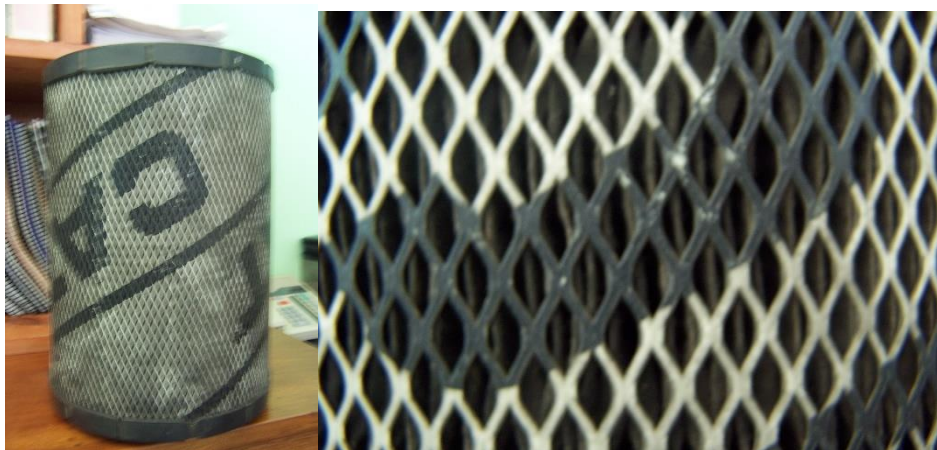
Figura 1. Filtro de aire
