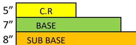
Figura 08. Espesor de pavimento flexible 2018.
