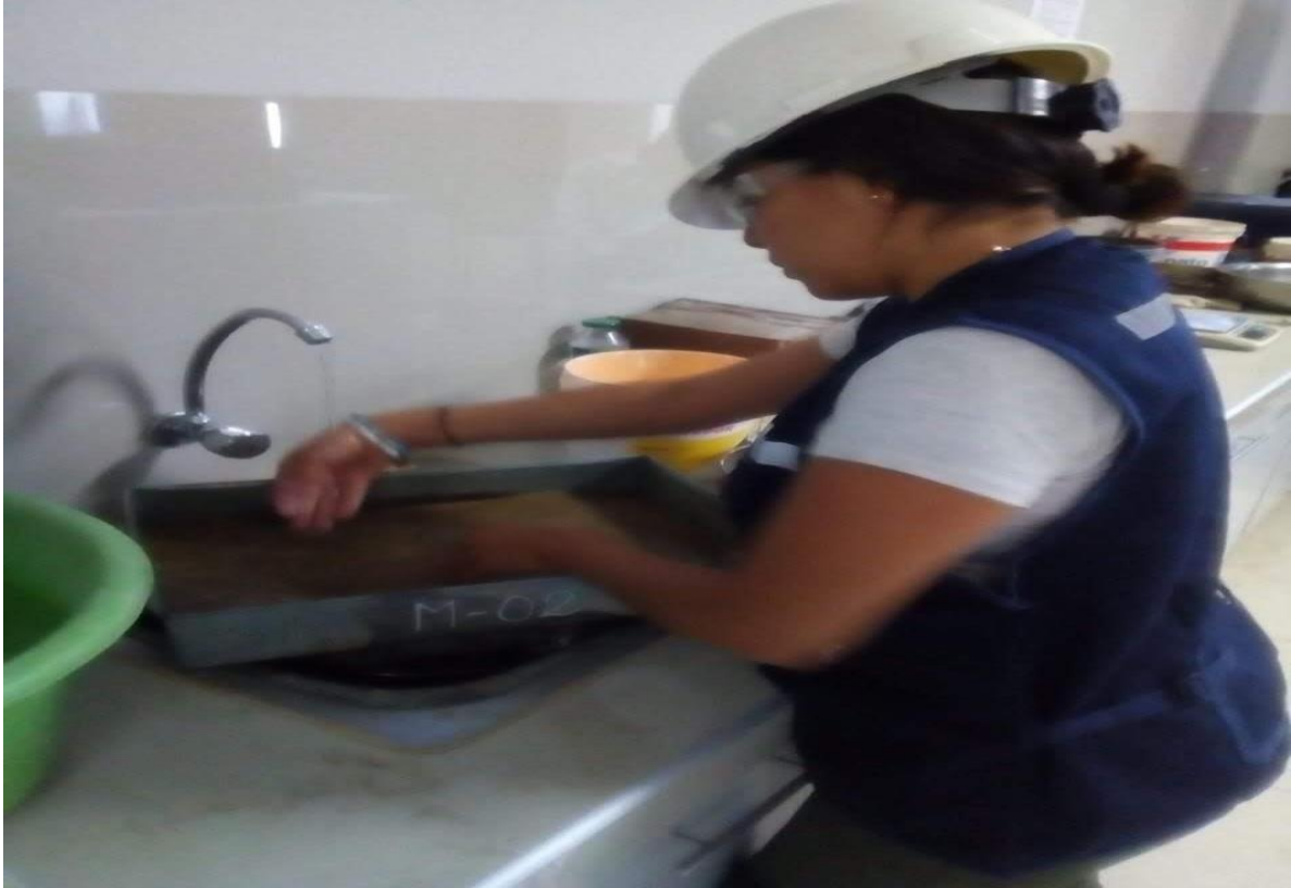
Fotografía: Lavado de agregado fino
