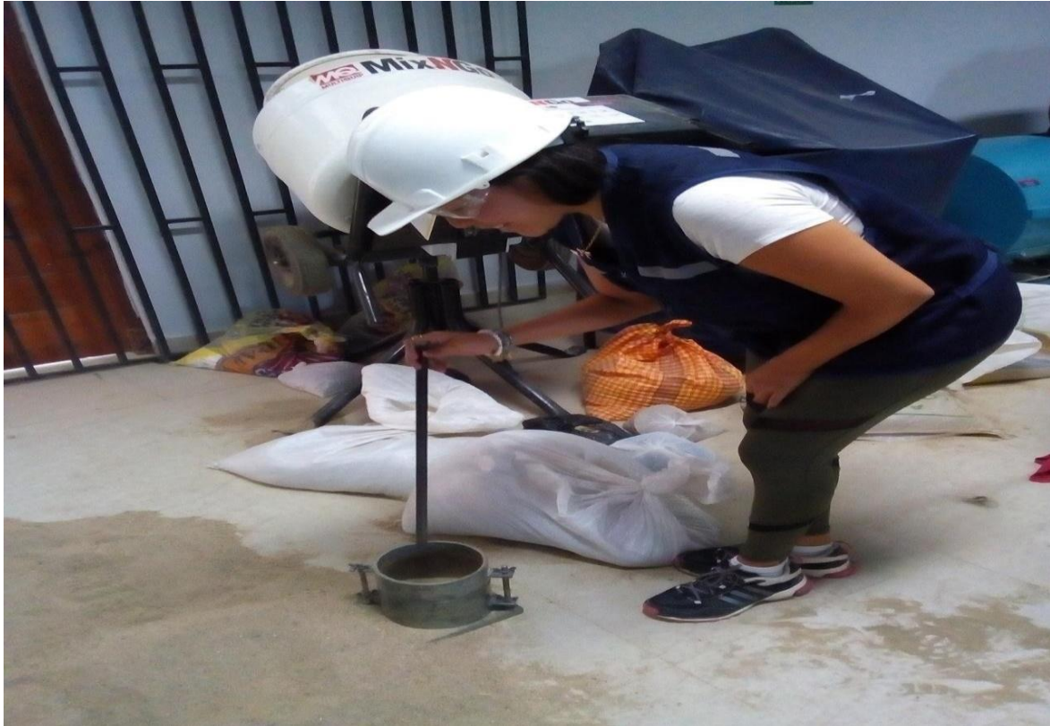
Fotografía: Ensayo de Slump
