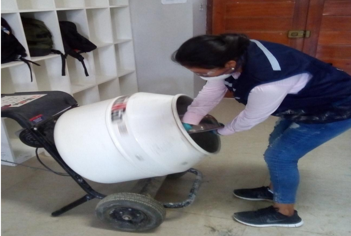
Fotografía: Preparación de mezcla para elaboración de bloques de concreto, utilizando caucho de neumático, agregado grueso y agregado fino.
