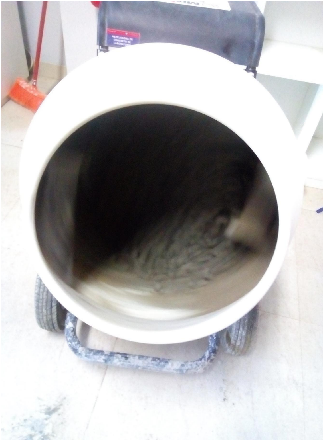
Fotografía: Mezcladora conteniendo mezcla para elaboración de bloques de concreto, utilizando caucho de neumático, agregado grueso y agregado fino.
