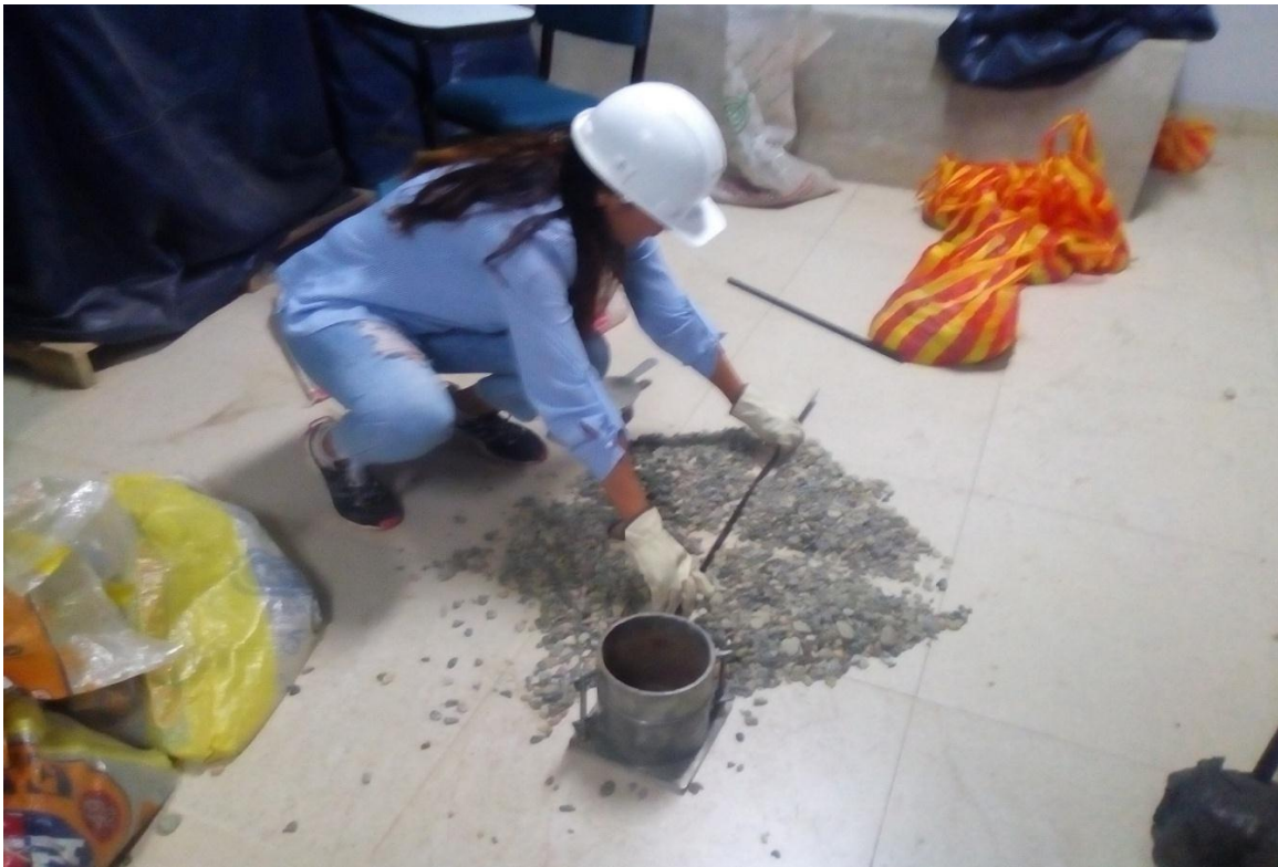
Fotografía: Cuarteo de agregado grueso
