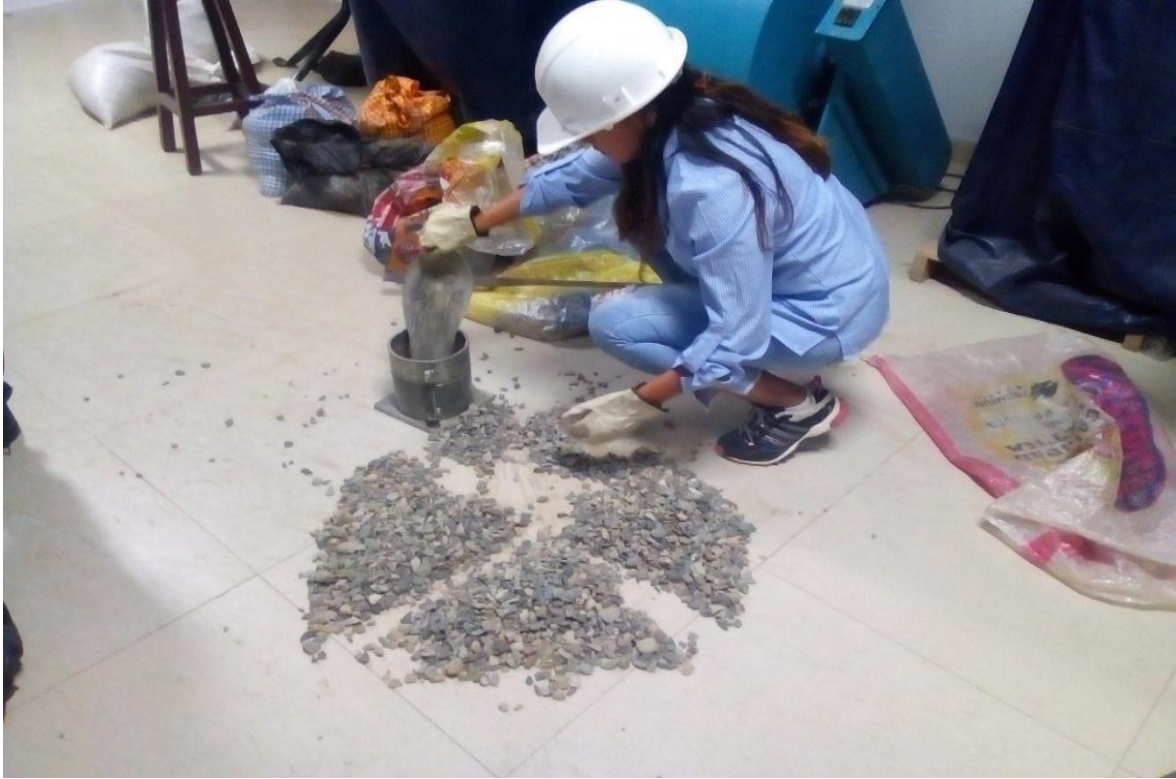
Fotografía: Cuarteo de agregado grueso
