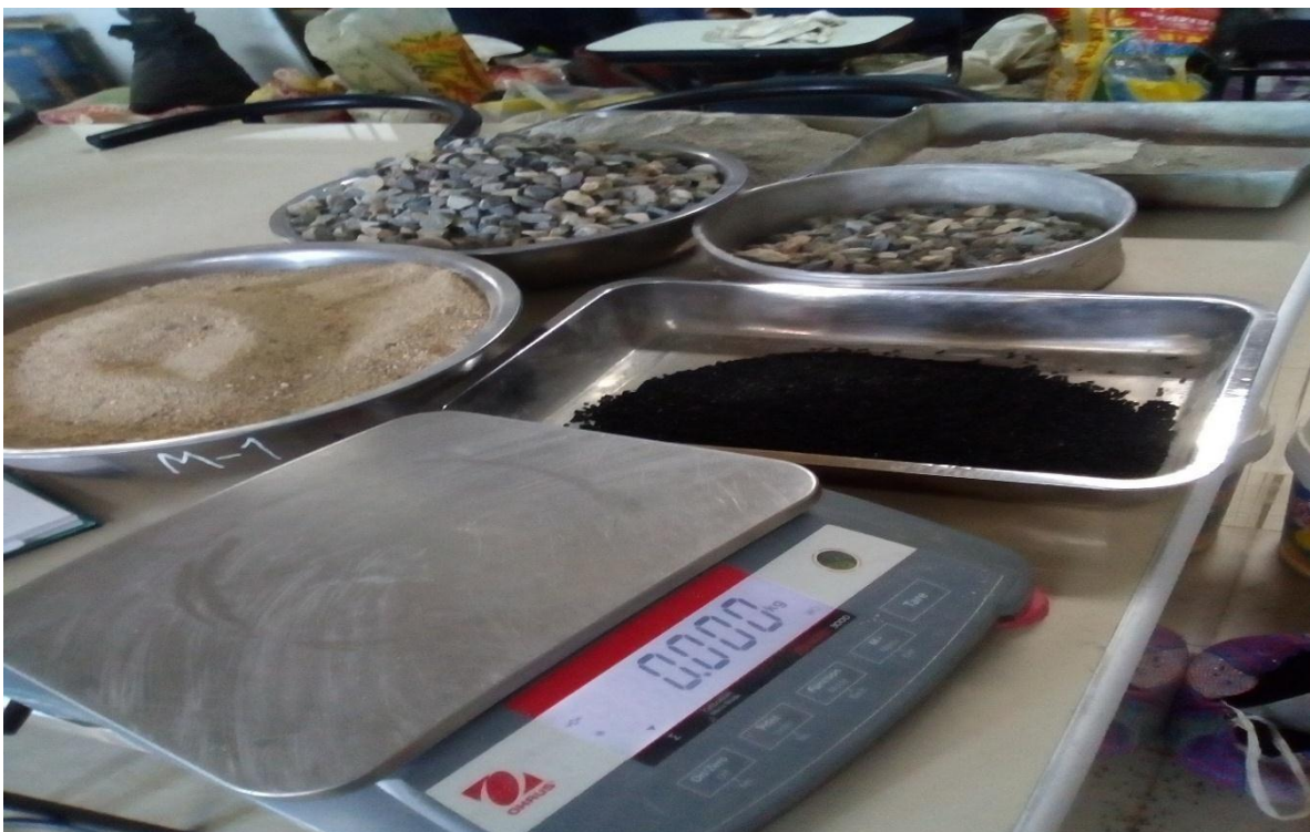
Fotografía: Balanza, caucho de neumático, agregado grueso y fino en proporciones para insumo de mezcla en la elaboración de bloques de concreto.
