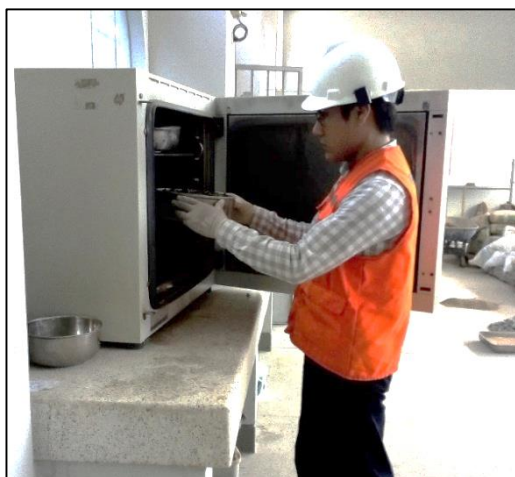
Introducción de muestra al horno
