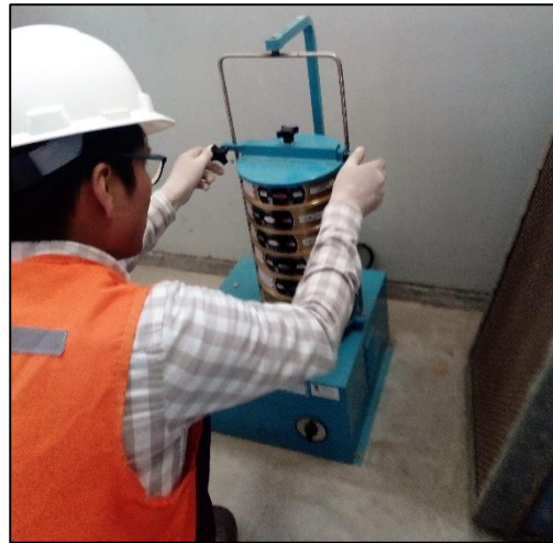
Instalación de equipo para tamizado
