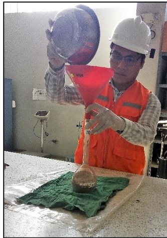
Introducción de muestra en fiola
