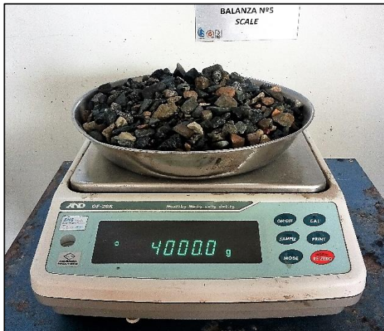
Peso de muestra superficialmente seca
