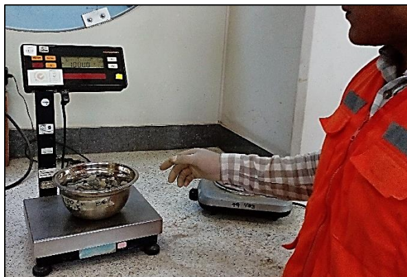
Peso de la muestra seca al horno
