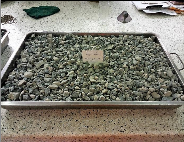
Muestra secada al horno
