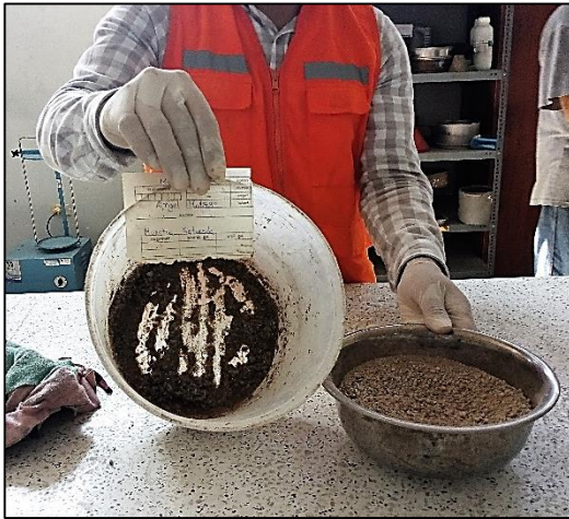
Muestra saturada y seca
