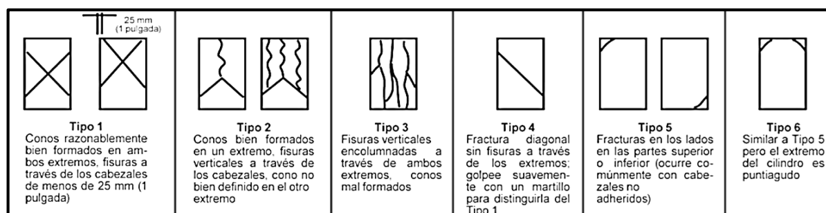
Figura 6: Tipos de fractura en probetas de concreto a compresión.
