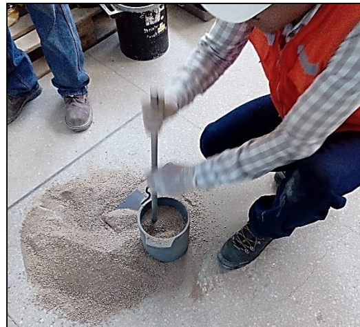
Compactado de muestra por varillado
