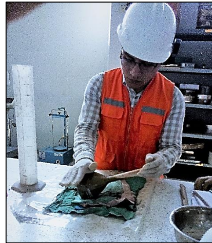
Mezclado de muestra y agua en fiola
