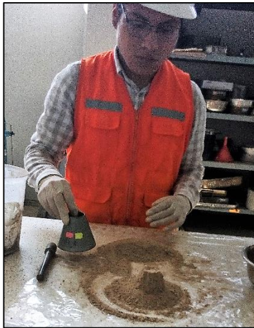
Determinación de superficie seca
