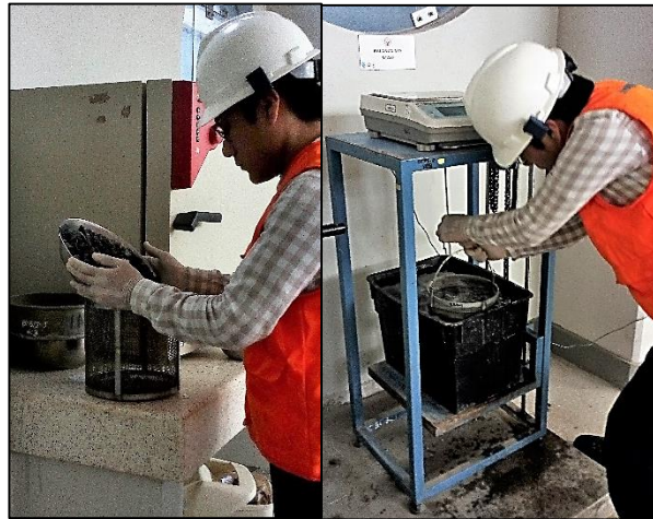
Introducción / sumersión de muestra en canastilla
