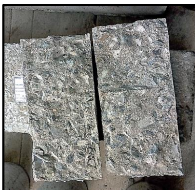
Probeta fracturada a tracción indirecta
