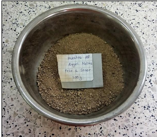
Peso de la muestra en estado ambiental
