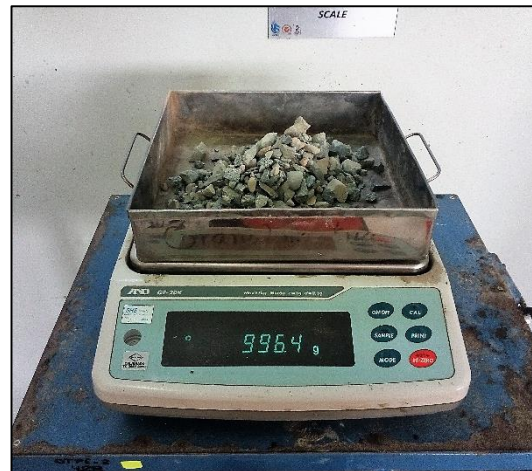
Peso de la muestra seca al horno
