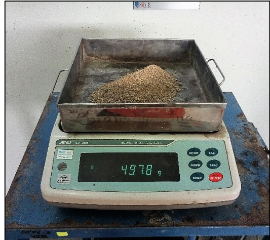
Peso de la muestra seca al horno
