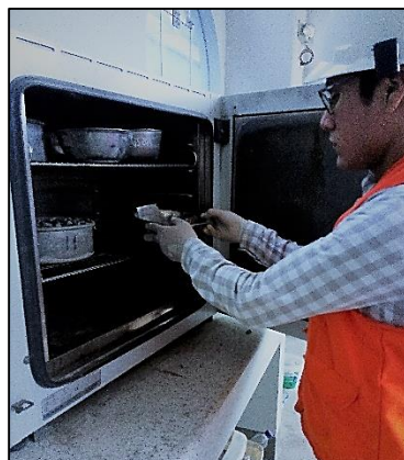
Introducción de muestra en fiola
