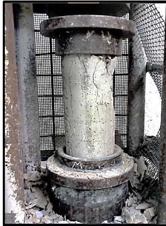
Ruptura (falla tipo 2)
