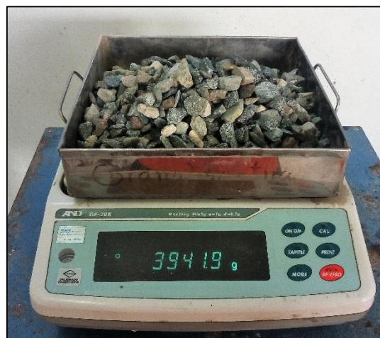
Peso de muestra seca al horno
