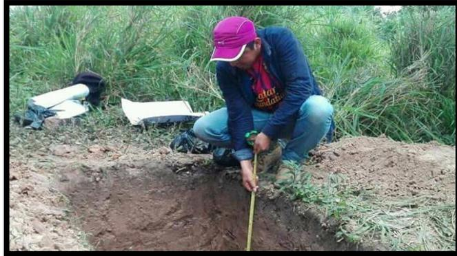
**CALICATA N° 01. PERFORACIÓN A TAJO ABIERTO, SE OBSERVA LA ESTRATIGRAFÍA DEL TERRENO, ASÍ MISMO SE TOMARON LAS MUESTRAS "IN SITU" PARA LOS ANÁLISIS Y PRUEBAS EN EL LABORATORIO.**
