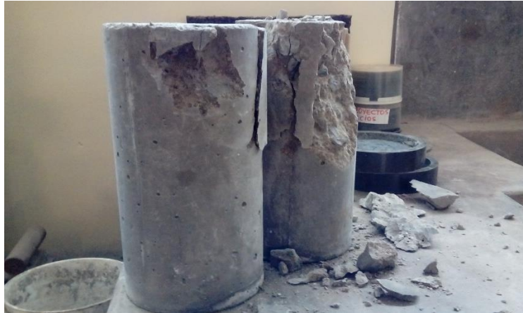
Figura 40. Rotura presentada por compresión en probetas patrón/monolíticas.
