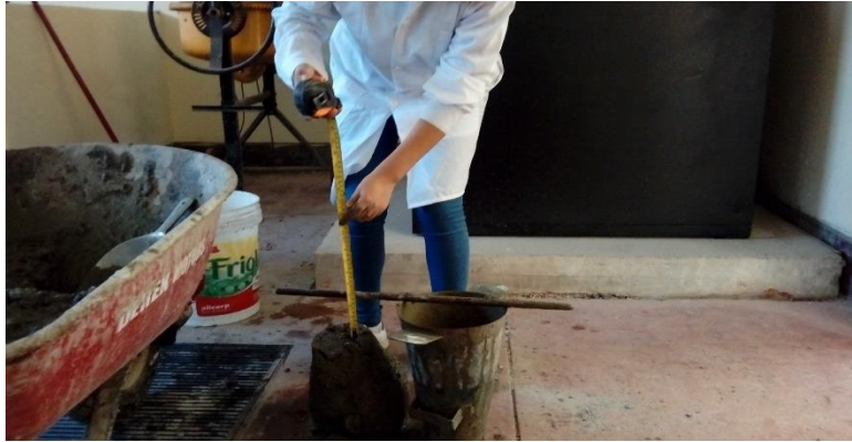
Figura 17. Medición del Slump.
