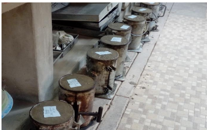
Figura 33. Segunda fase de llenado de probetas sin aplicación del puente de adherencia.
