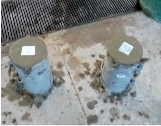
Figura 27. Llenado de las probetas y vigas de concreto.
