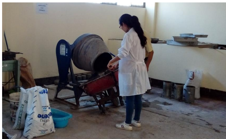
Figura 26. Elaboración de la mezcla de concreto.
