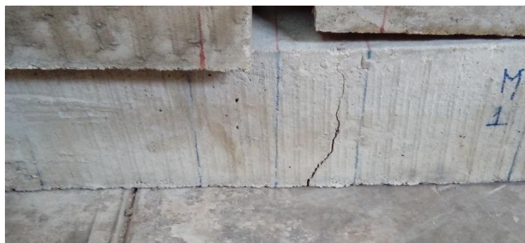
Figura 50. Rotura presentada por flexión en vigas patrón/monolíticas.
