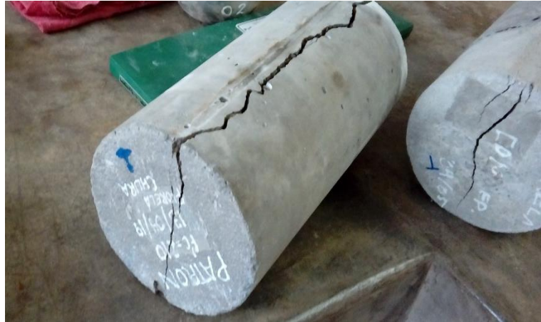
Figura 44. Rotura presentada por tracción en probetas patrón/monolíticas.
