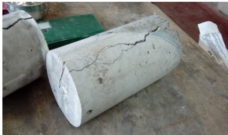
Figura 45. Rotura presentada por tracción en probetas con puente de adherencia Sikadur 32 Gel.
