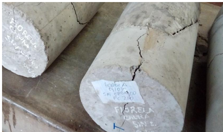
Figura 46. Rotura presentada por tracción en probetas sin tratamiento.
