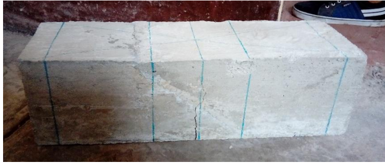
Figura 51. Rotura presentada por flexión en vigas con puente de adherencia Sikadur 32 Gel.
