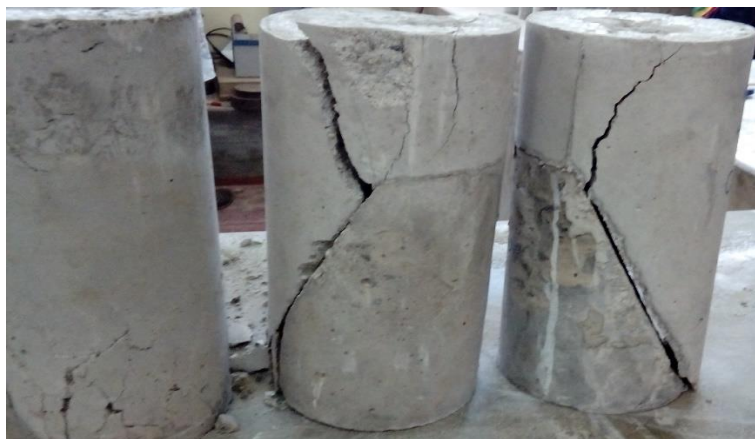
Figura 42. Rotura presentada por compresión en probetas sin tratamiento.
