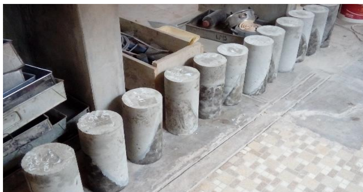
Figura 32. Desencofrado de las probetas cilíndricas luego de la aplicación de Sikadur 32 Gel.
