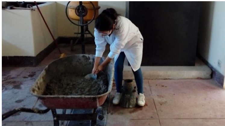
Figura 16. Colocación de la mezcla en el Cono de Abrams.
