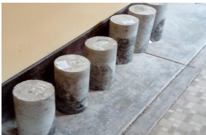
Figura 34. Desencofrado de probetas sin aplicación del puente de adherencia.
