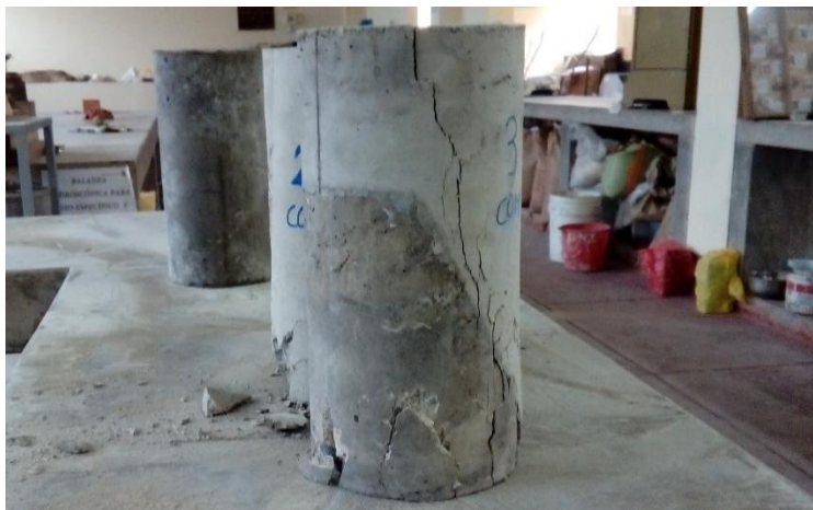
Figura 41. Rotura presentada por compresión en probetas con puente de adherencia Sikadur 32 Gel.
