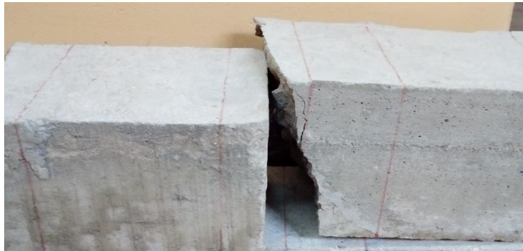
Figura 52. Rotura presentada por flexión en vigas sin tratamiento.
