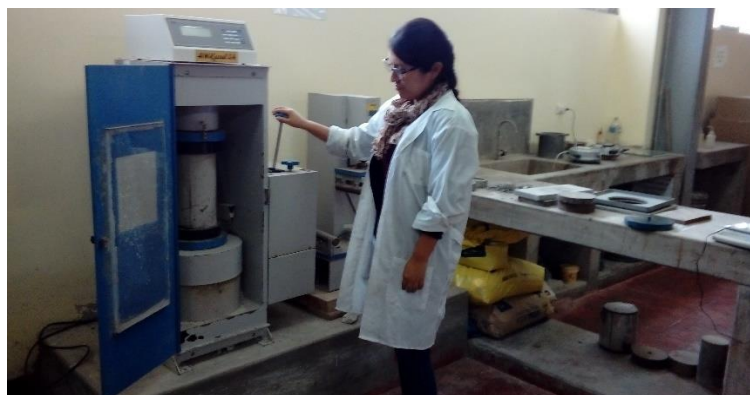
Figura 39. Realización del ensayo de resistencia a compresión.
