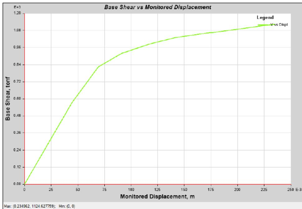
Figura 12: Curva de Capacidad de la estructura en Y-Y
