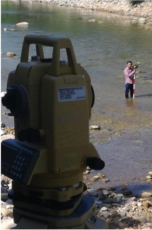
FOTO 05: Vista de la recolección de puntos con los prismas.
