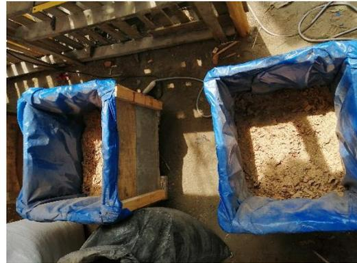
Figura 6: ingreso de la primera capa de aserrín 2 Kg.
