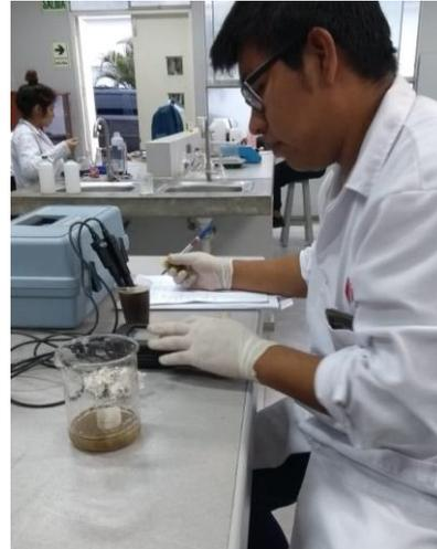
Figura 39. Medida del de pH, conductividad y temperatura
