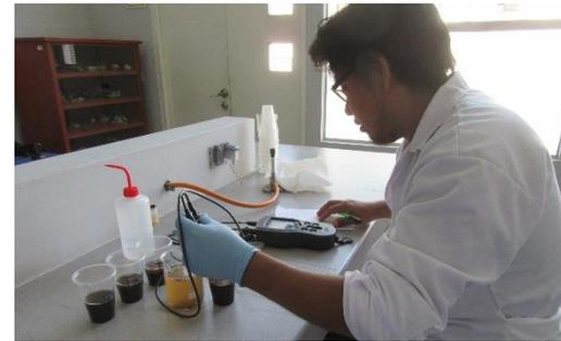
Figura 22: medición de temperatura, pH y conductividad eléctrica.
