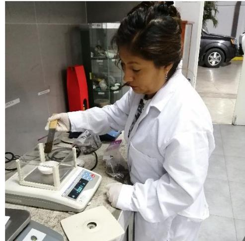
Figura 37. Peso de 50 g de humus para el análisis de pH, conductividad y temperatura
