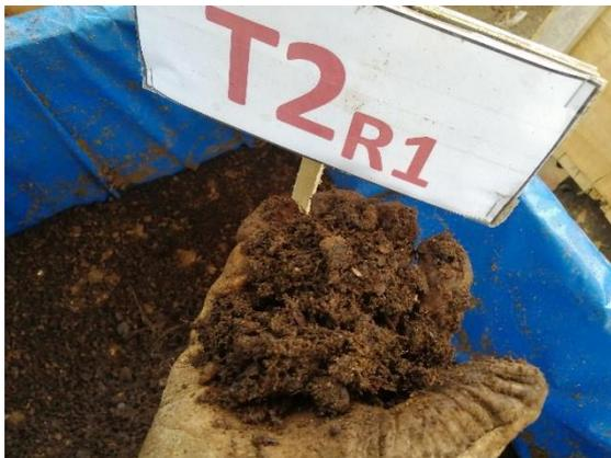
Figura 17: medición de humedad, técnica del puño cerrado
