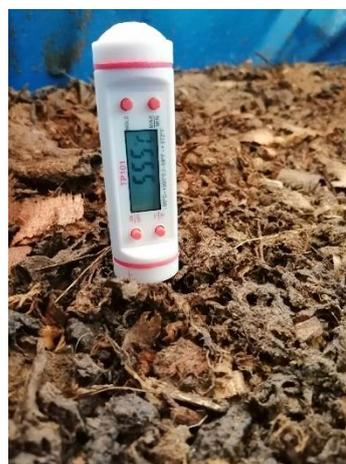
Figura 15: medición de temperatura por cada tratamiento
