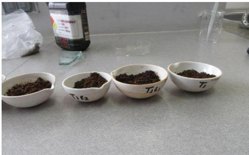
Figura 23: pesado de 10 gramos de compost para la prueba de humedad
