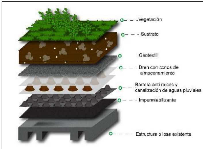
Figura 53. Funcionamiento del techo verde
