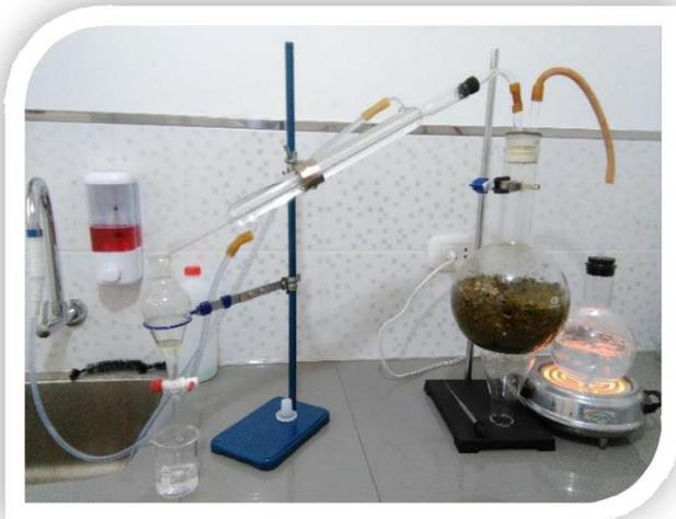
Proceso de destilación del aceite de *Chenopodium ambrosioides* (Paico) por proceso de destilación por arrastre con vapor de agua
