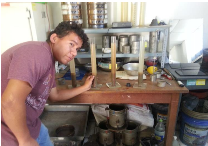
FOTO 6: Ensayo Equivalente de Arena. (reposo de muestras durante 10 minutos).
