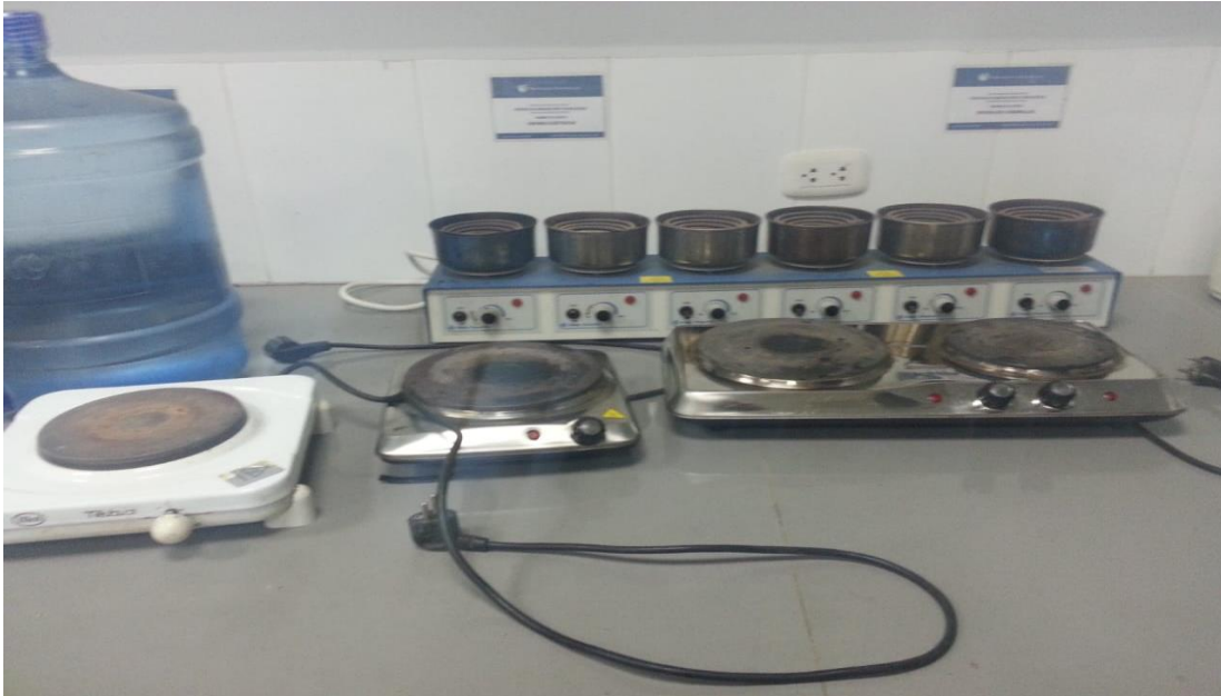
FOTO 9: Estufas para el calentamiento de los materiales.
