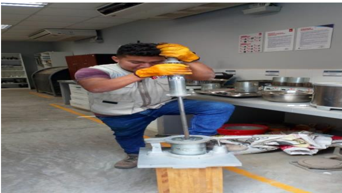
FOTO 16: Martillo compactador 75 golpes por cada cara de las briquetas.
