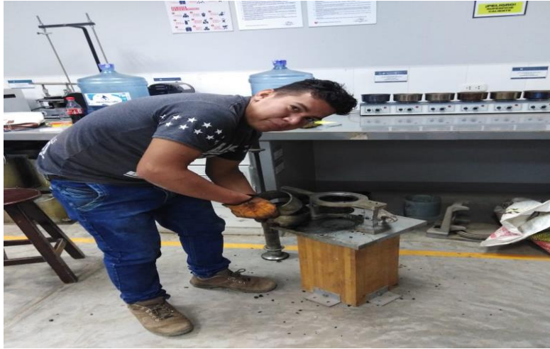
FOTO 11: Pedestal para la compactación.
