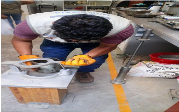
FOTO 15: Mezcla en molde para la compactación.
