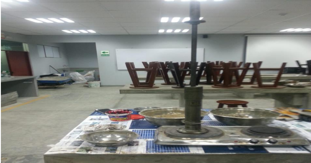
FOTO 10: Calentamiento del martillo Marshall a una temperatura de 90°C a 150° C.
