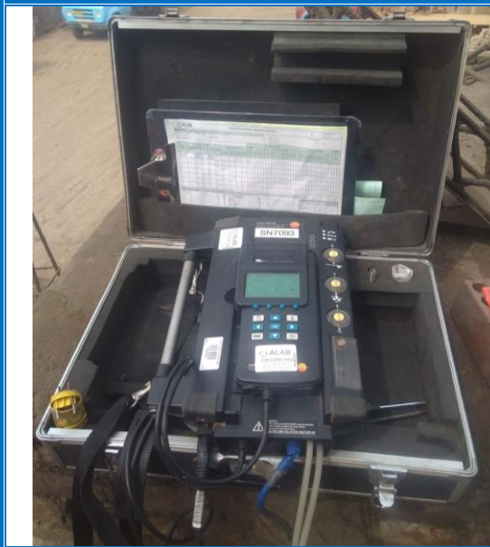
Fotografía 04: Analizador de gases Testo 350XL (equipo utilizado en el monitoreo de emisiones).
