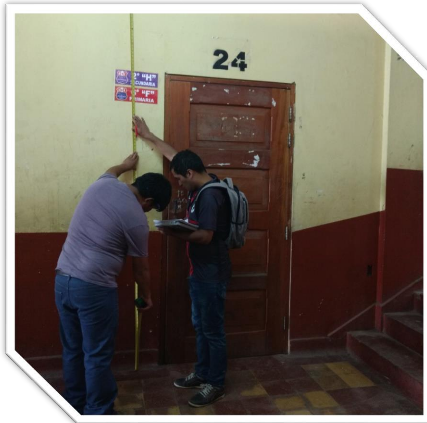
Figura 01 y 02 Toma de datos de campo (medición de la infraestructura para la elaboración de planos)
