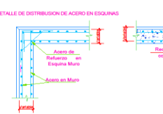
SECCION TIPICA DE ARMADURA MURO DEL RESERVOIRIO Esc. 1/25
