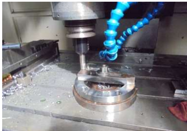
Figura n°24. Proceso de maquinado base soldables. Fuente. Elaboración propia.
