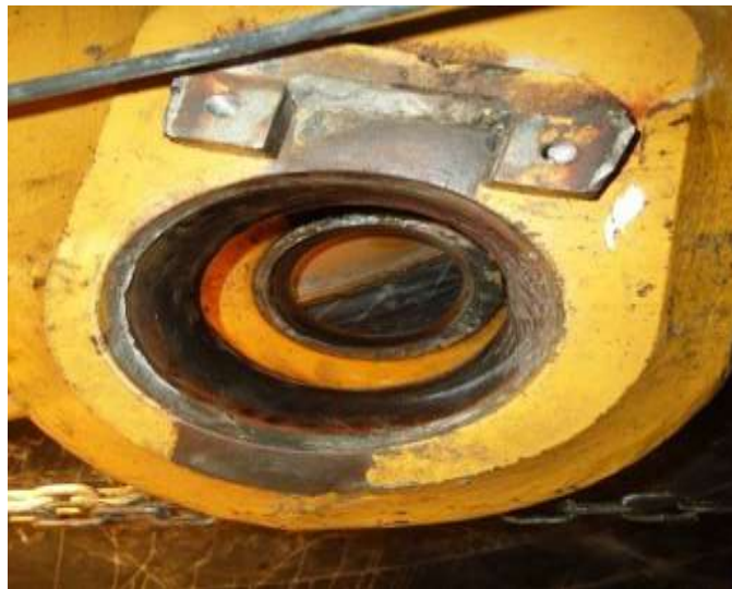
Figura n°8 alojamiento quedan en malas condiciones. Fuente: Elaboración propia
