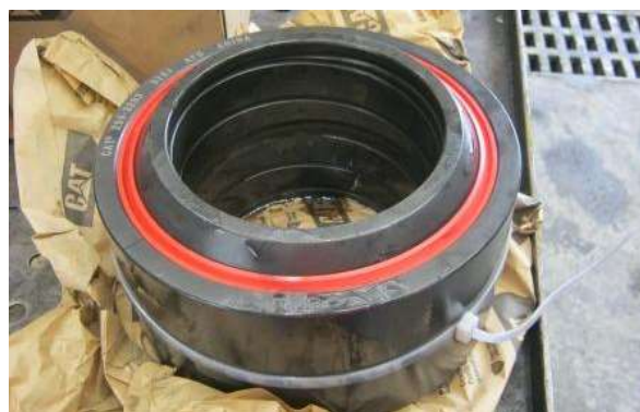
Figura n°10. Rodamiento oscilante original. Fuente. Elaboración propia.
