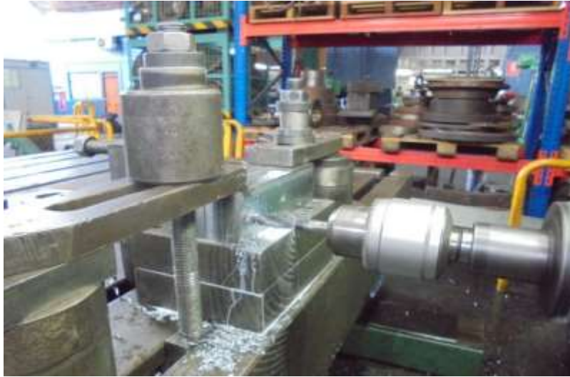
Figura n°25. Proceso de maquinado de Key Hard. Fuente. Elaboración propia.
