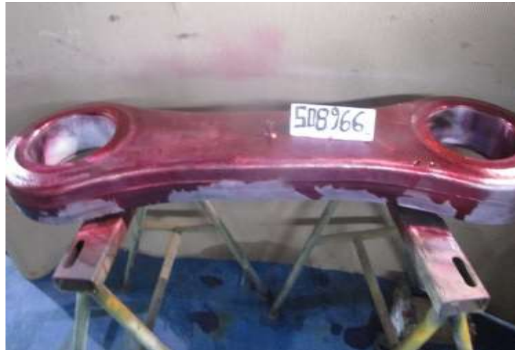
Figura n°21. Proceso de prueba de tintes. Fuente. Elaboración propia.
