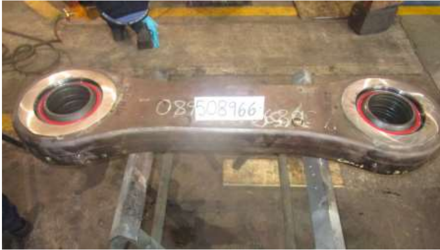
Figura n°27. Proceso de instalación de rodamiento oscilante. Fuente. Elaboración propia.
