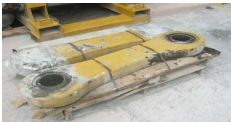
Figura n°18. Barras Link retiradas del camión. Fuente. Elaboración propia.
