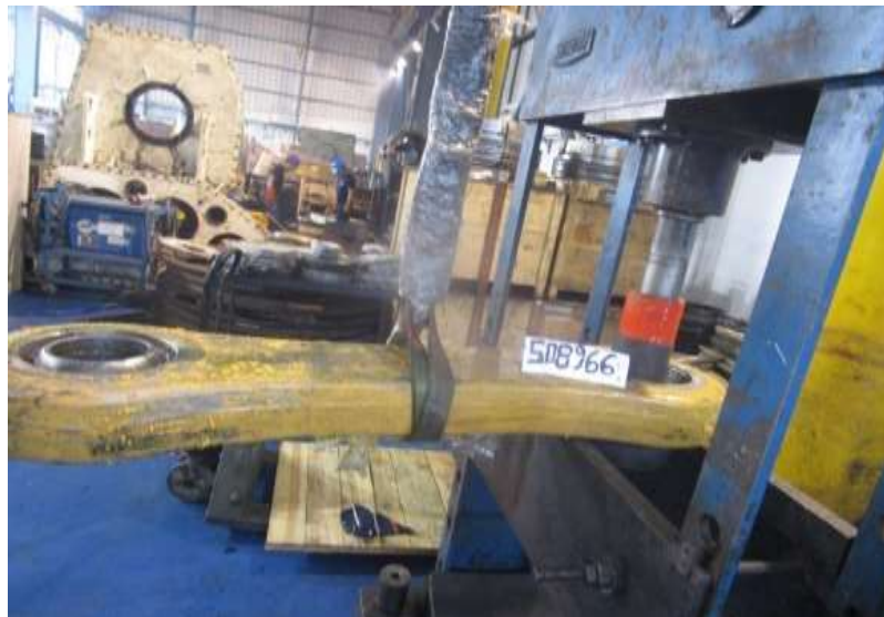
Figura n°20. Proceso de retiro de repuestos de la Barras Link. Fuente. Elaboración propia.
