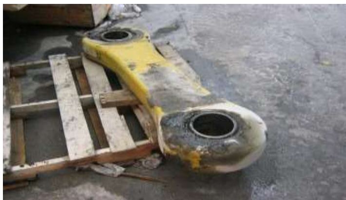
Figura n°11. Barra Link retirada de camión CAT793F. Fuente. Elaboración propia.
