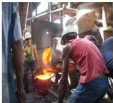
Horno basculante con timón y caja de cambios de camion para el giro vaciando aluminio derretido en callana.
