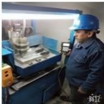
Maquinando matriz de plataforma N° 9 para botas de damas.
