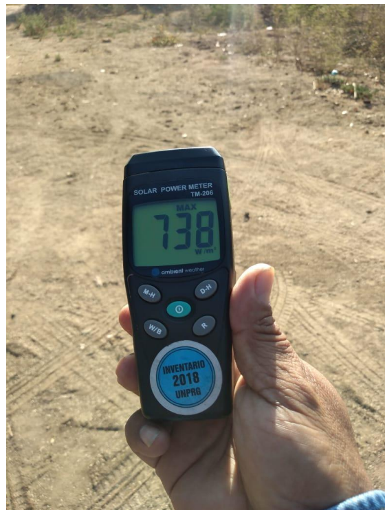
Vista fotográfica donde se aprecia la toma de datos en w/m2
