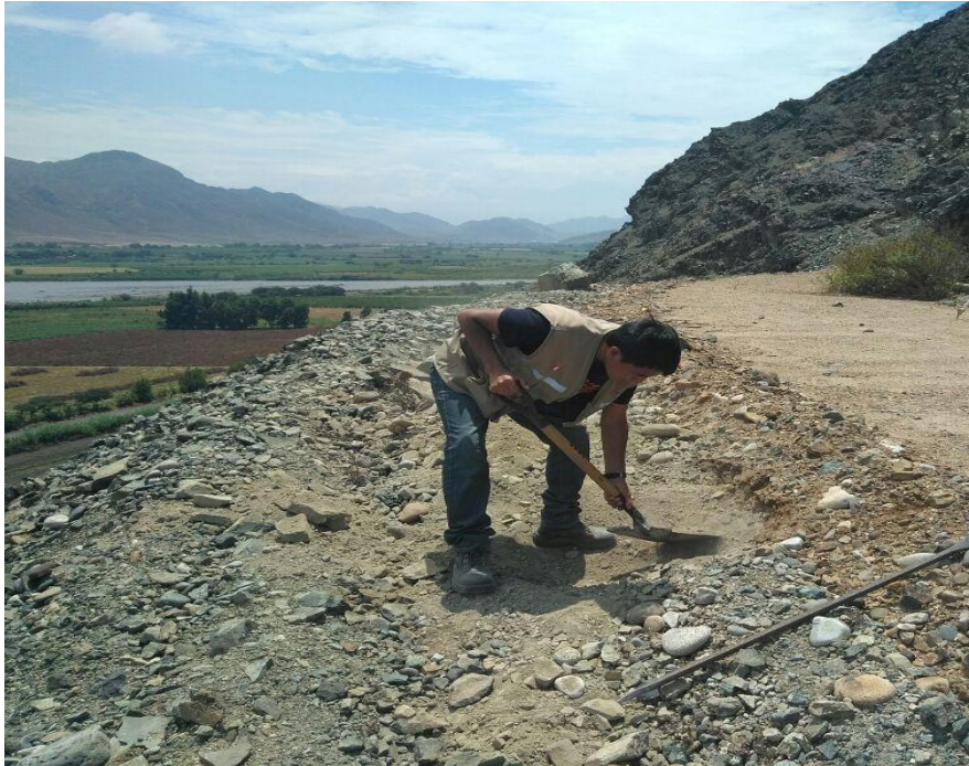
Fotografía. N° 14. Se da inicio a la extracción de la muestra N°03 correspondiente a la calicata N°03.
