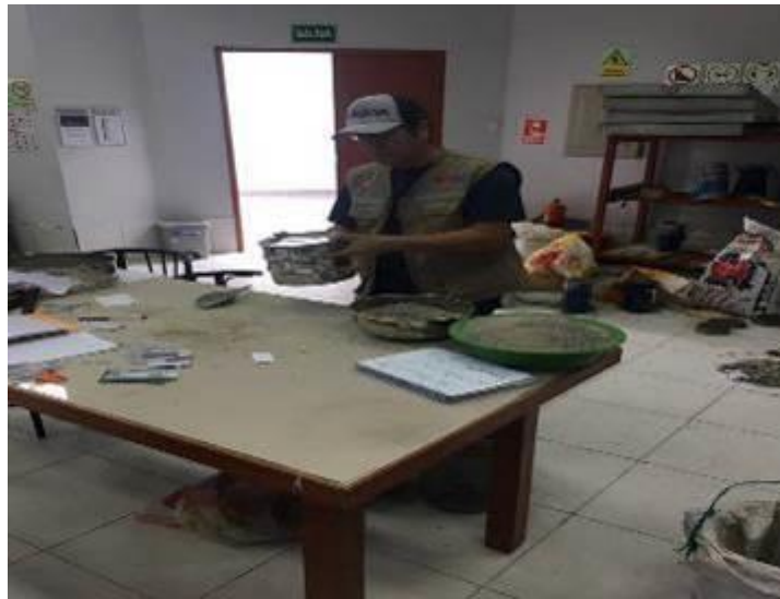
Tamizando el concreto reciclado triturado
