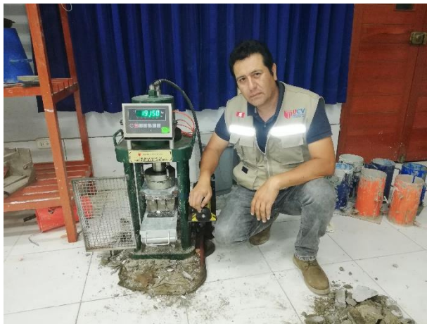
Muestra de Concreto Reciclado Nº 5: Resultado Presión de 163,10 Kg/ cm 2
