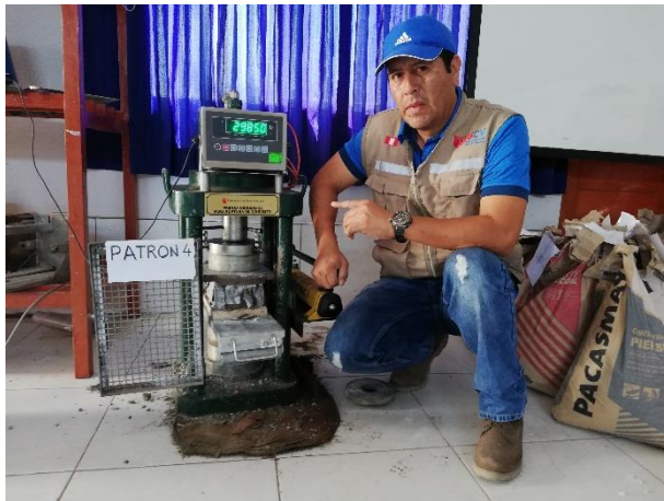
Muestra Patrón N° 4: Resultado Presión de 160,21 Kg/ cm 2
