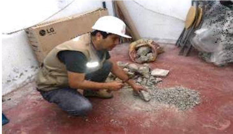
Triturado concreto reciclado
