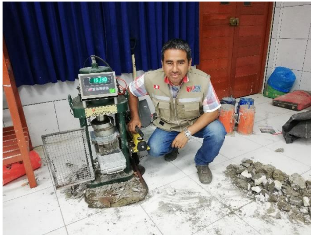
Muestra de Concreto Reciclado Nº 4: Resultado Presión de 160,78 Kg/ cm 2
