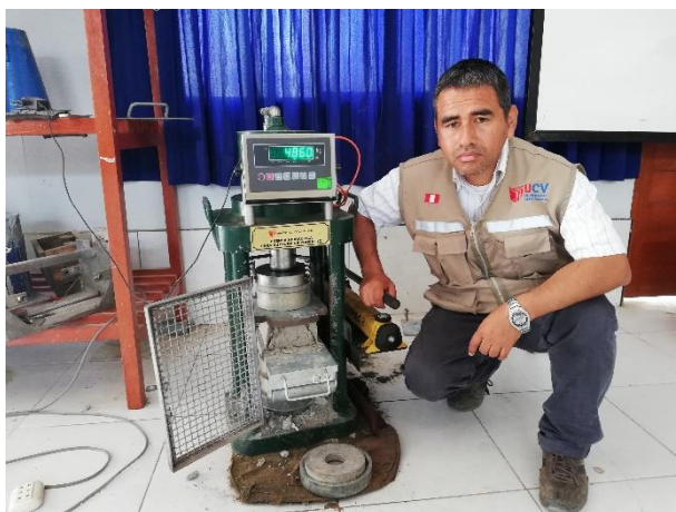
Muestra Patrón N° 5: Resultado Presión de 173,14 Kg/ cm 2
