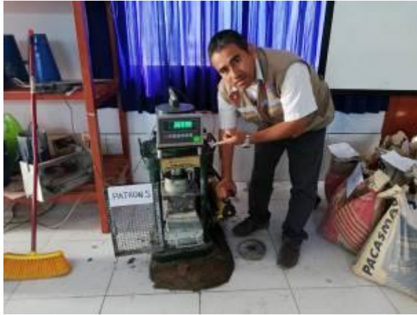
Muestra Patrón N° 3: Resultado Presión de 162,98 Kg/ cm 2
