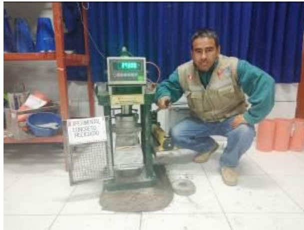
Muestra de Concreto Reciclado N° 1: Resultado Presión de 161,89 Kg/ cm 2
