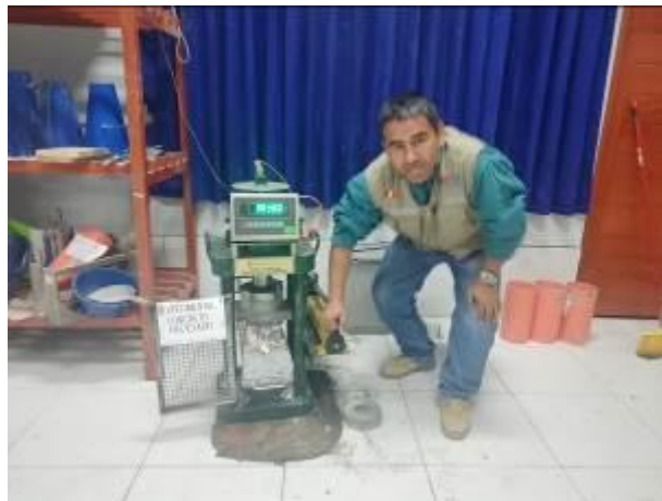
Muestra de Concreto Reciclado N° 2: Resultado Presión de 161,41 Kg/ cm 2
