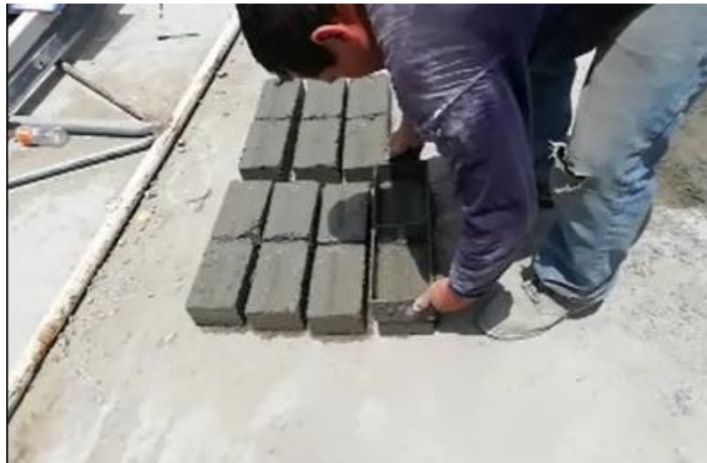
Desmolturación del ladrillo
