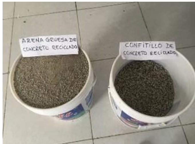
Agregados de concreto reciclado tamizados
