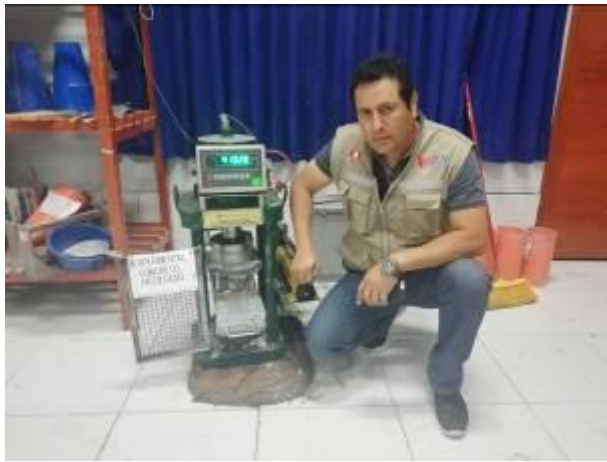
Muestra de Concreto Reciclado Nº 3: Resultado Presión de 160,70 Kg/ cm 2
