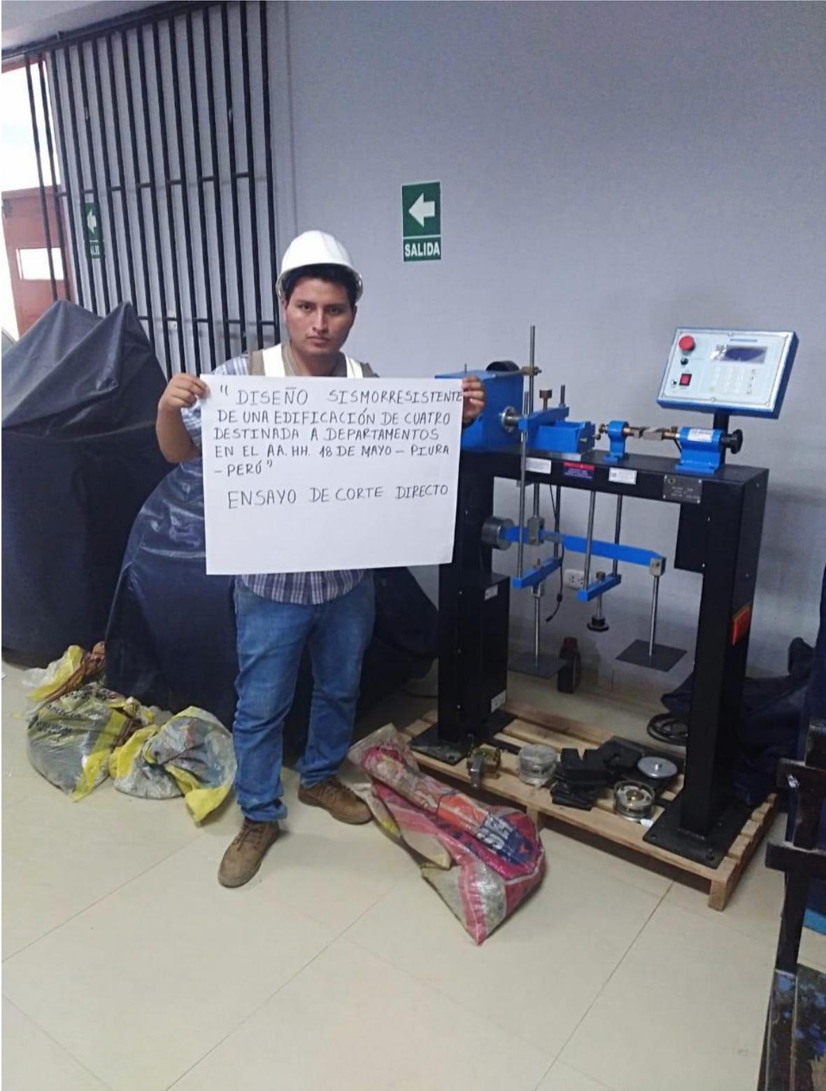
Figura 30 Ensayo de corte directo
