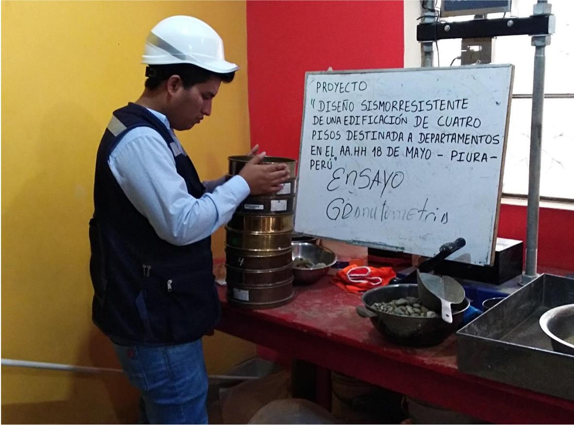
Figura 28 Ensayo de granulometria
