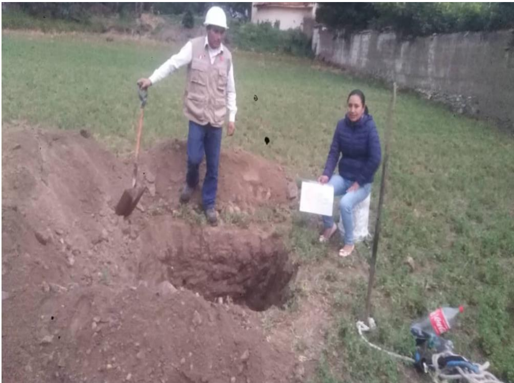
Fotografía N° 03 – 04: Calicatas – toma de muestras de suelo.
