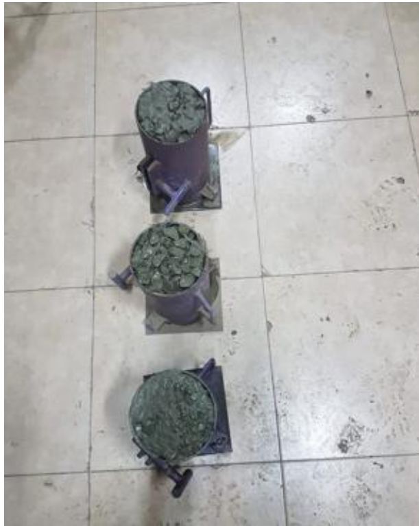
Foto 17. Probetas terminadas y listas para su secado
