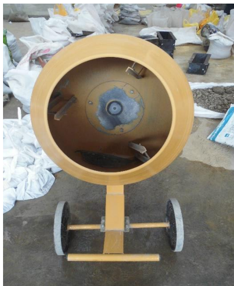
Mescladora de concreto de 0.03m 3
