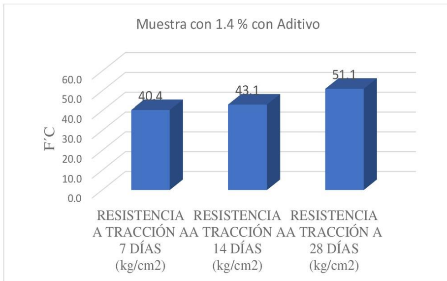
Figura 15: Resultado del ensayo de la resistencia a tracción del concreto convencional con adición de 1.4 % de aditivo a la edad de 7,14 y 28 días
