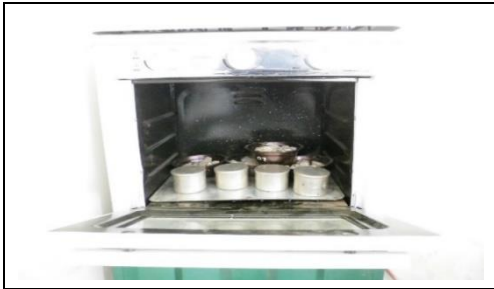
Figura 1. Puesta al horno del agregado fino
