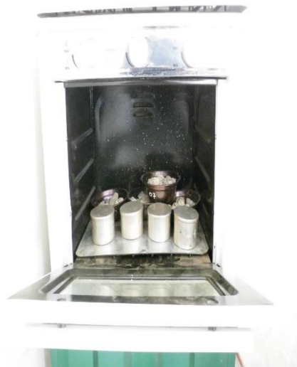
Colocación del agregado grueso al horno a 110^{\circ}\text{C} \pm 5^{\circ}\text{C} .
