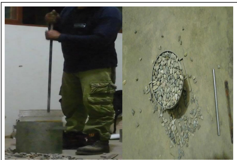
Figura 5: Peso unitario suelto y compactado del agregado grueso
