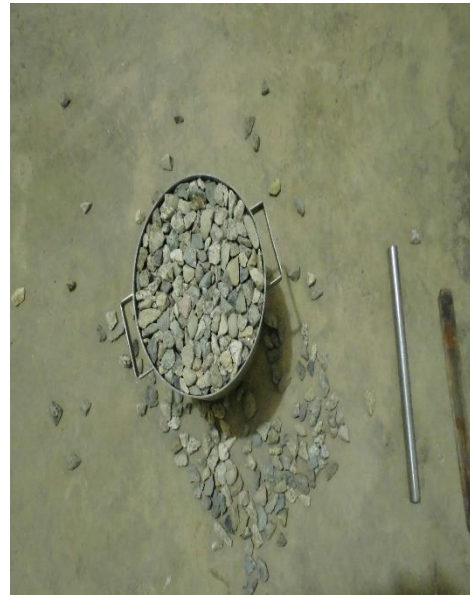
Agregado grueso compactado
