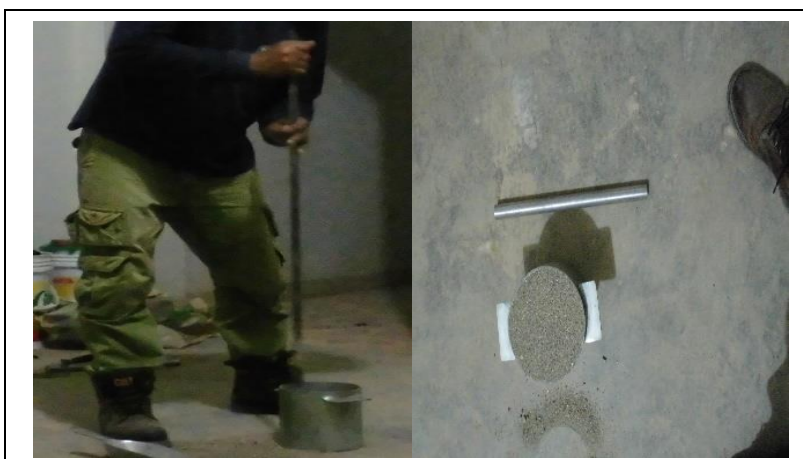
Figura 2: Peso unitario suelto y compactado del agregado fino
