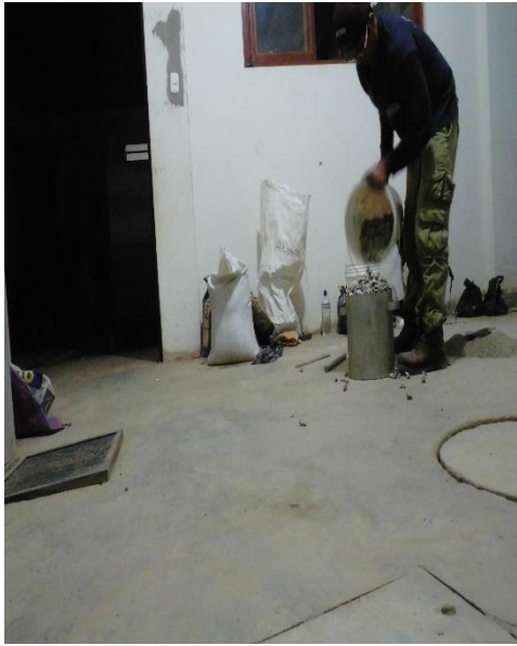
Proceso peso suelto del agregado grueso
