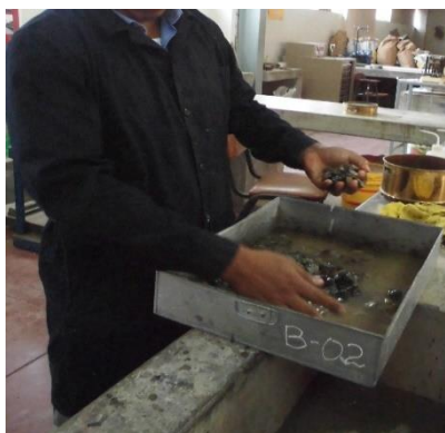
Figura 4: Lavado y posterior saturado del agregado grueso
