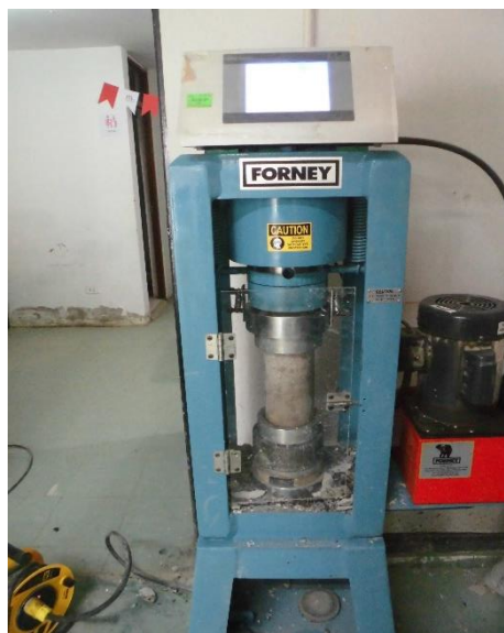
Prensa de concreto
