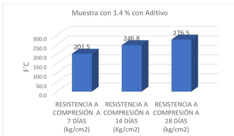
Figura 11: Resultados del ensayo de la resistencia a la compresión 7,14 y 28 días con adición de 1.4 % de aditivo
