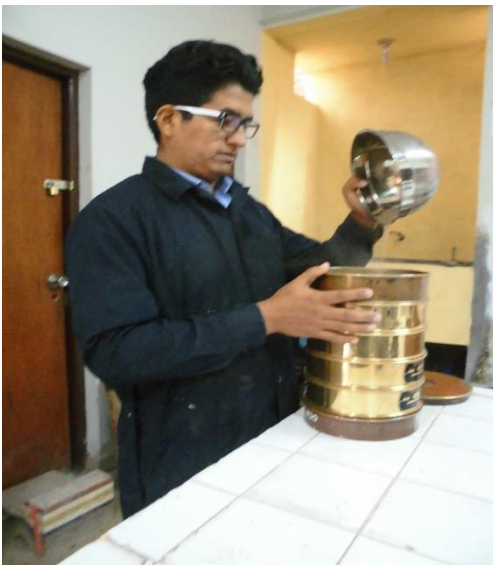
Tamizado del agregado fino
