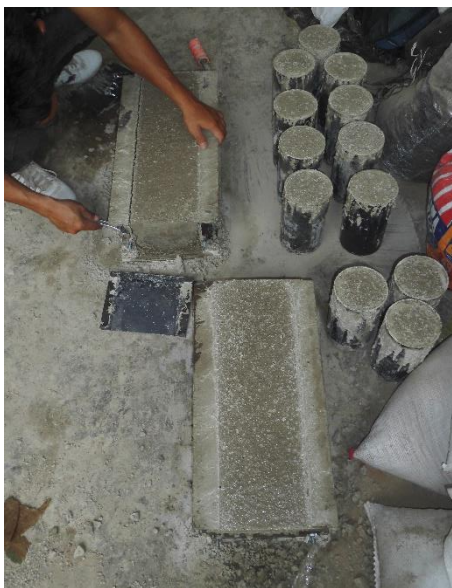
Desmolde de las vigas
