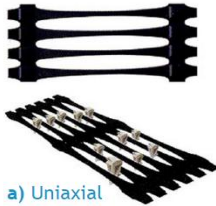
Figura 20. Trabazón de suelos en geomalla uniaxial
