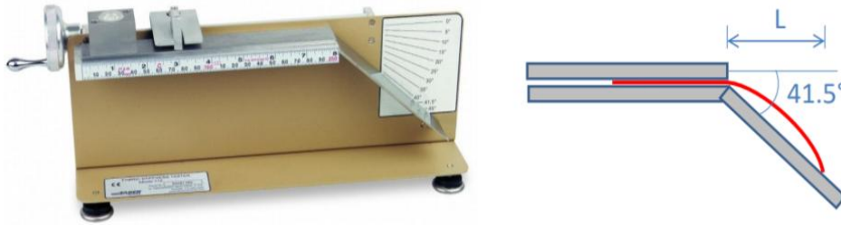
Figura 25. Esquema de ensayo de rigidez flexional
