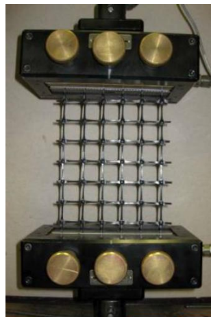
Figura 17. Ensayo de resistencia la rotura en geomalla Fuente: Cersa, 2018
