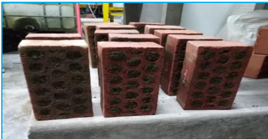
Figura 26. Unidades de Albañilería con Alveolos llenos.
