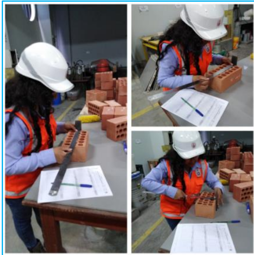
Figura 30. Procedimiento de Variación Dimensional
