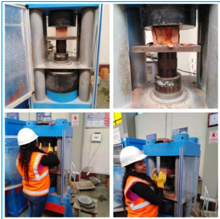
Figura 29. Ensayo de Resistencia a la compresión
