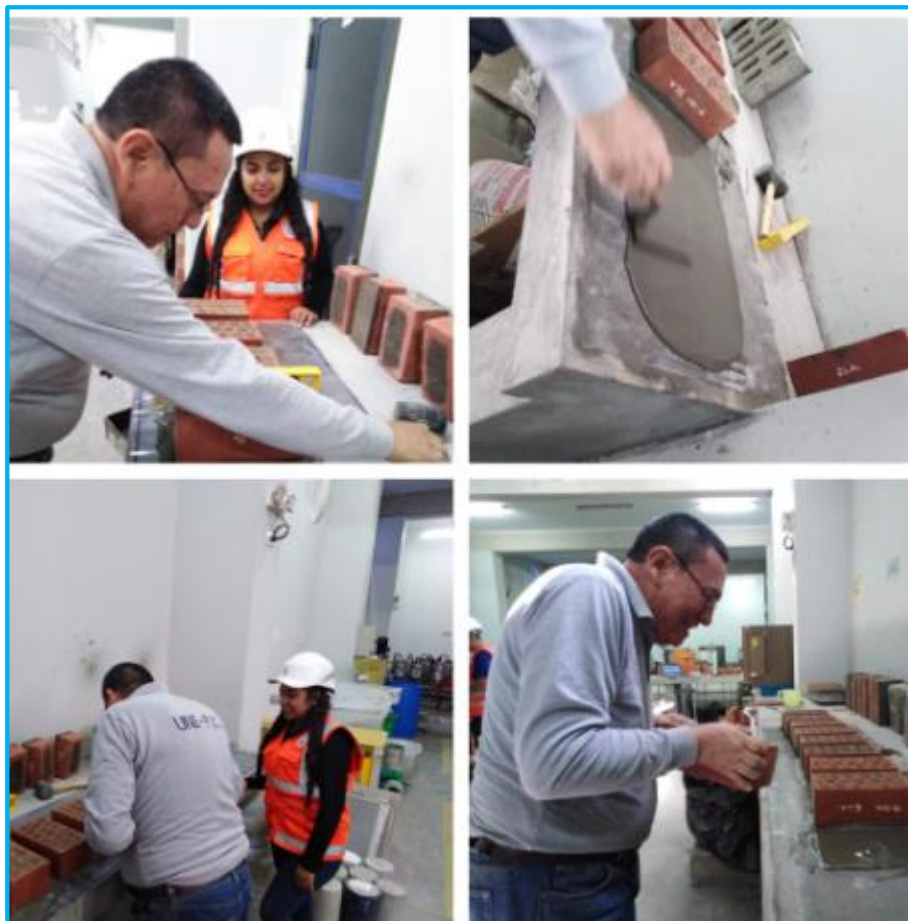
Figura 27. Procedimiento de refrentado con yeso y cemento.
