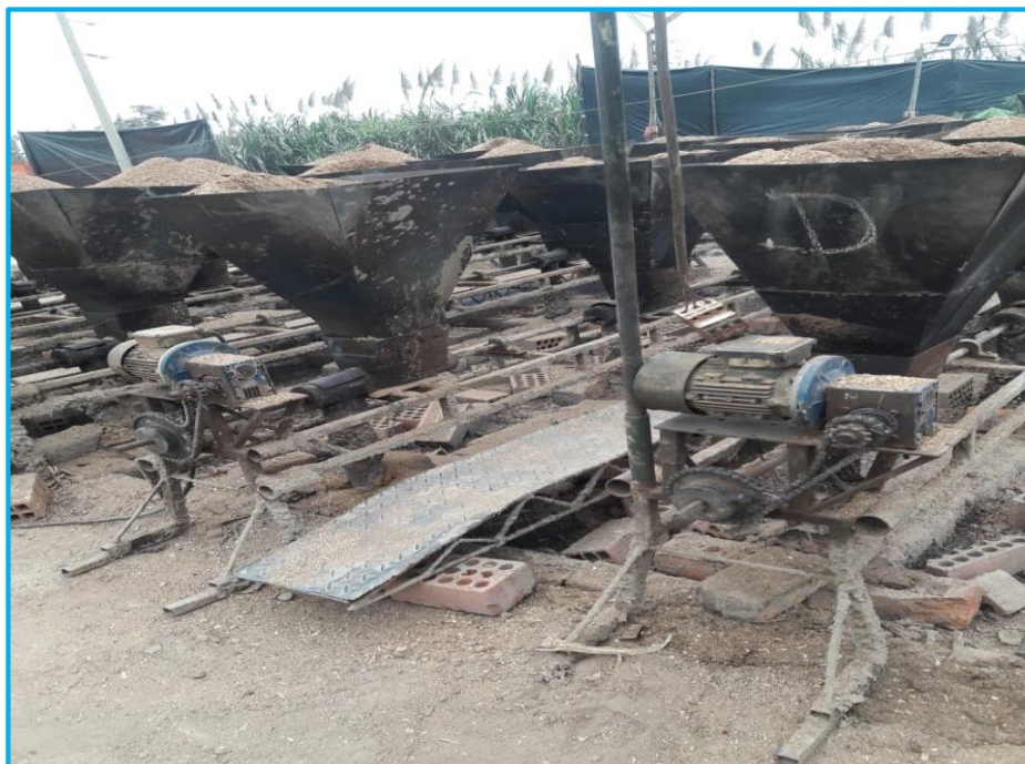
Figura 17. Embudos con aserrín y cáscara de café.
