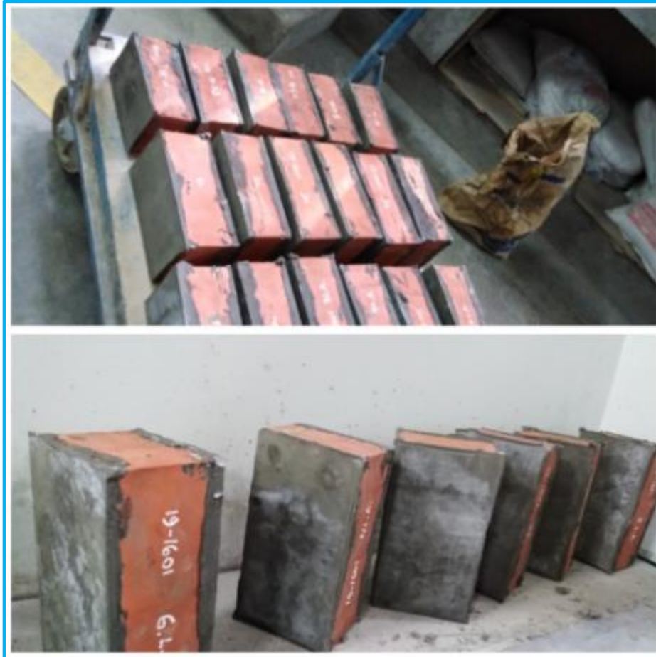
Figura 28. Procedimiento de refrentado con yeso y cemento en ambas caras.
